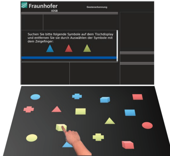
Abb. 4.11: Auf dem Tisch dargestellte Symbole müssen gemäß Aufgabenbeschreibung auf dem Sekundärmonitor per Berührung mit dem Zeigefinger selektiert werden. Nach der Selektion eines passenden Symbols wird dieses ausgeblendet. 1
