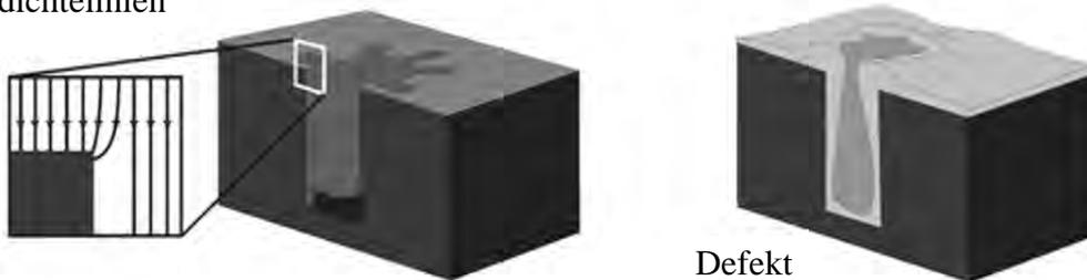
Abbildung 17: Schematische Darstellung der Anordnung der Stromdichtelinien bei einkomponentigen, isotrop leitfähigen Bauteilen und des Defektes, der sich durch die Galvanoformung auf diesen Substratplatten ergibt
