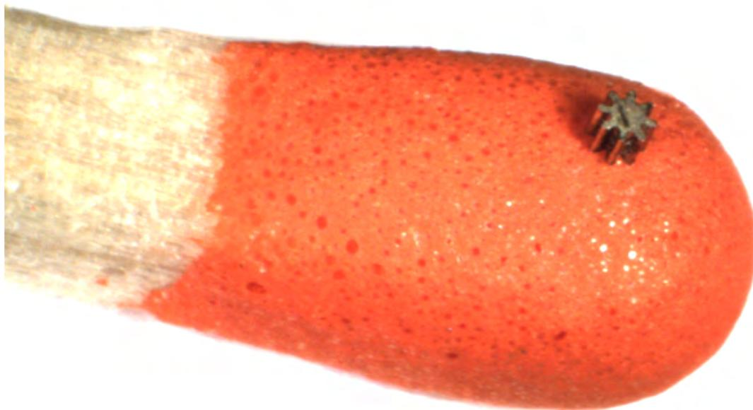
Abbildung 66: Foto eines mit optimierten Parametern hergestellten Mikrozahnrad auf dem Kopf eines Streichholzes
