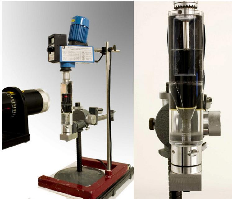
**Abbildung 5-3: LDA Messeinrichtung zur Bestimmung der Strömungsgeschwindigkeiten im Bereich der rotierenden Matrix**
