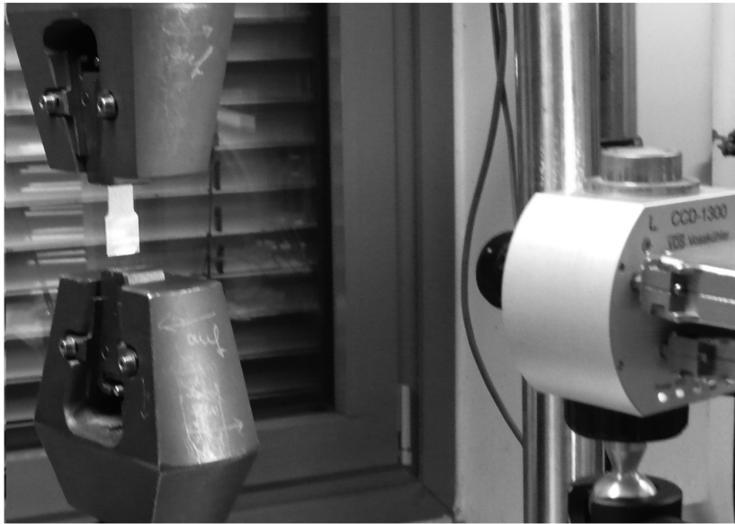
Abb. 2.7.: 2D-Messaufbau mit hydraulischer Prüfmaschine (10 kN) mit maßstäblich verkleinerten Proben
