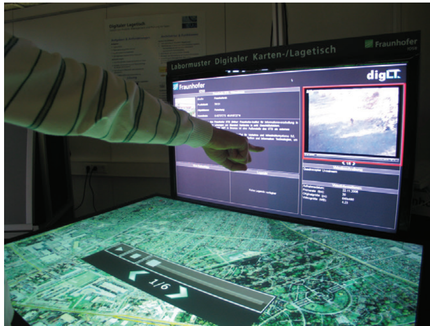
Abb. 4.9: PointMenus : Eine neuartige, im Rahmen der Arbeit entwickelte Technik für die Interaktion mit entfernten Anzeigen in einer Multi-Display-Umgebung.
