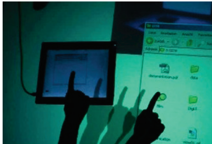
Abb. 4.2: Lift-and-Drop : Eine neuartige im Rahmen dieser Arbeit entwickelte Interaktionstechnik für displayübergreifendes Verschieben von Objekten im Greifraum des Benutzers.
