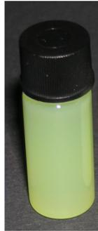
Abbildung 3.21.: CuMoO<sub>4</sub> (unmittelbar nach der Synthese) als Suspension in EtOH
