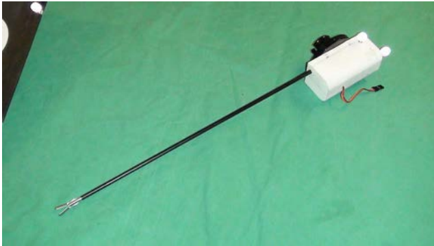
Bild 7.5.: Entwickelter End-Effektor für MIRS Szenarien
