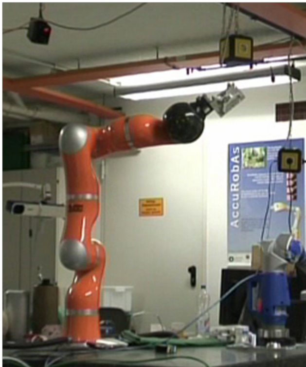
Bild 6.18.: Registrierung zwischen Roboter und dem Trackingsystem
