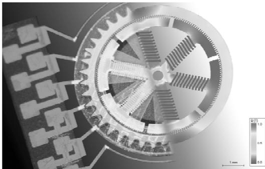
**Bild 2:** Mikromotor und elektromagnetisches Modell
