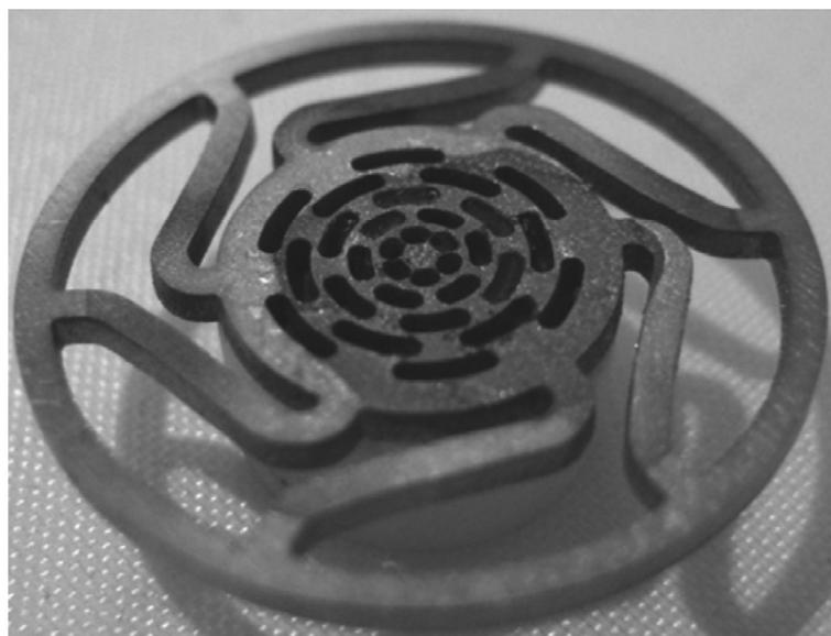
**Bild 7:** Metallischer Träger der ersten Generation zur stoffschlüssigen Fügung eines Pellets
