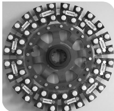
**Bild 4:** Demonstrator mit ofengelöteten H-Trägern mit Aluminiumoxidpellet
