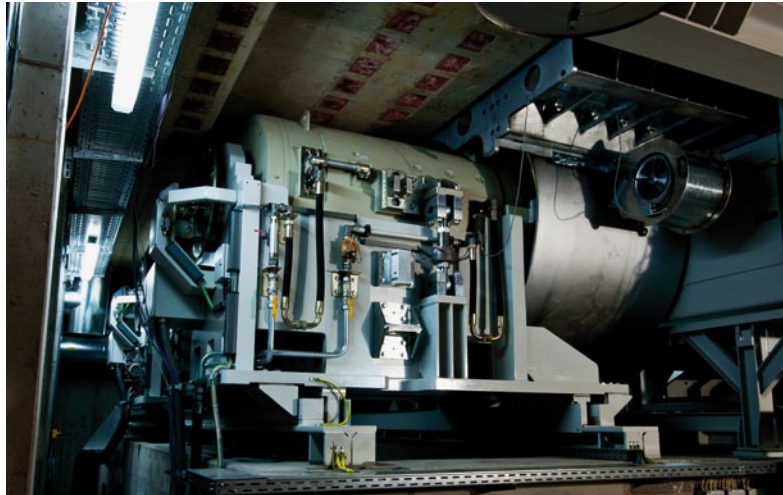
④ Motor-Laufrollen-Einheit des Akustik-Allradrollenprüfstand Motor-roller unit of the acoustic four-roller chassis dynamometer
