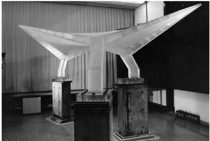
Y) Messmodell für das Hyperschalendach des Hallenschwimmbads Sechslingspforte [Alsterschwimmbad] in Hamburg 1956–1973
