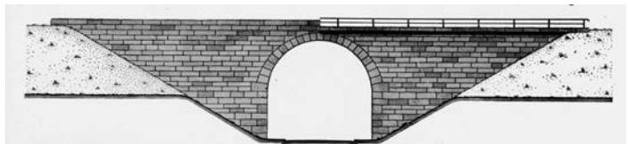
Abb. 114. Wegunterführung mit Halbkreisgewölbe. Links massive Brüstung, rechts Gesims und stählernes Geländer
