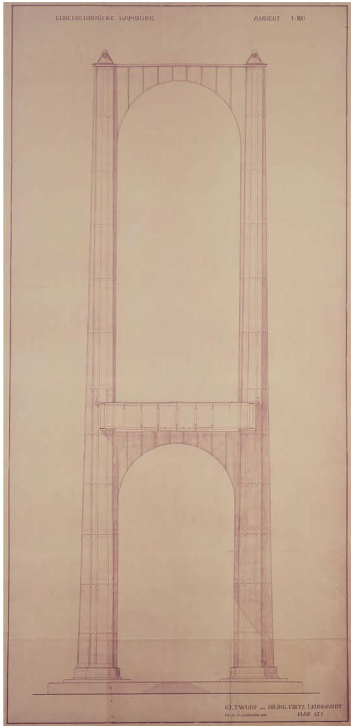
1) Gegenentwurf Fritz Leonhardts für den Pylon der Elbehochbrücke in Hamburg in Stahl 1939
