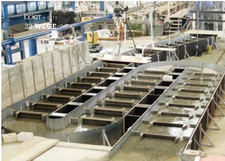
Auf dem Prüfstand: Wasserbauingenieure am KIT testeten den Betrieb der Anlage im Labor.
