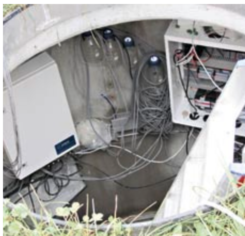
Feinste Messtechnik auf der grünen Wiese: Die drei Tonnen schweren Lysimeterzylinder am Standort Fendt liefern Bodenmessungen.
