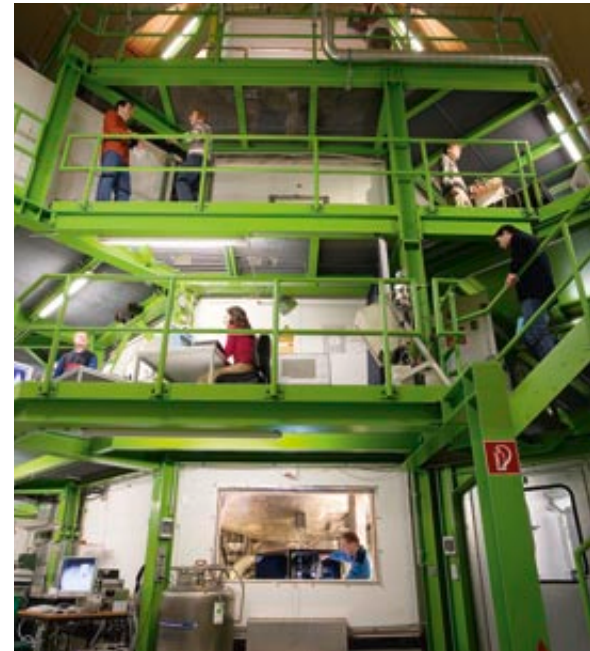
Realistische Bedingungen: In der AIDA-Versuchsanlage simulieren Forscher am KIT eine künstliche Atmosphäre, um die Auswirkungen von Spurengasen, Aerosol und Feinstaub zu untersuchen.
