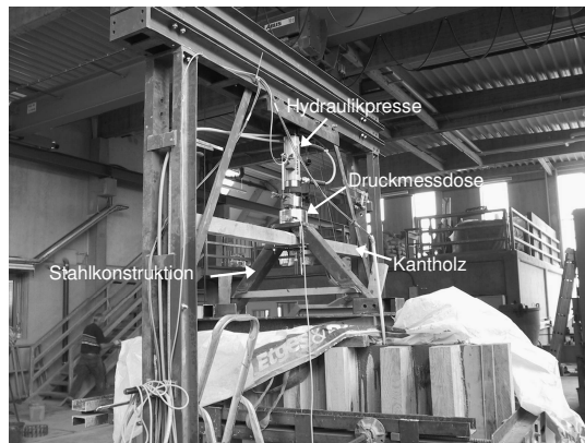
Bild 3.3: Detailansicht der Auflasteinrichtung (bestehend aus Stahlrahmen, Hydraulikpresse, Druckmessdose, Kantholz und Stahlhilfskonstruktion) zur Einbauhöhen-simulation
