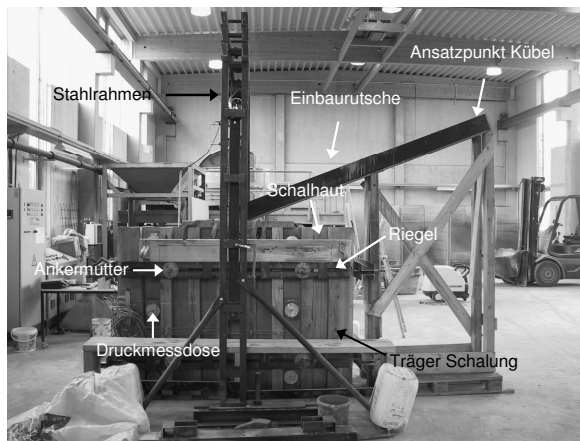
Bild 3.7: Rutsche für den Einbau der frischen Betone bzw. Mörtel in das verwendete Modellschalungssystem – Anordnung zusammen mit Schalung und Stahlrahmen
