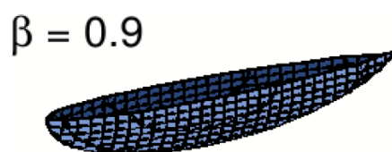
Abbildung 2.4: Abstrahlcharakteristik der Synchrotronstrahlung im Laborsystem.
