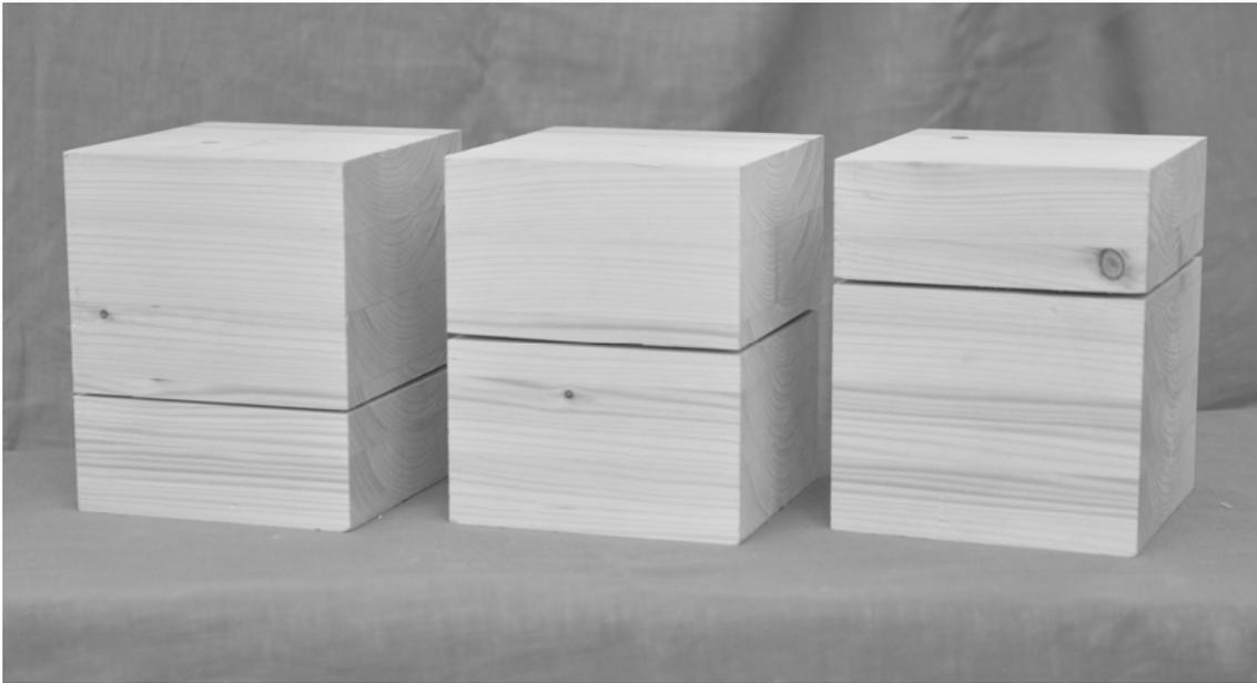
Abbildung 12: Prüfkörper für Einschraubversuche mit Spannschrauben. Druckmessung jeweils in den Einschraubtiefen 50 mm; 100 mm und 150 mm.
