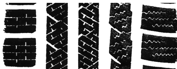
Bild 4–52: Reifen „Winter Sport“ - mittlere Breite der Profilelemente: l_{Siy} = 23 mm; mittlerer Abstand der Feinschnitte (in Fahrtrichtung): l_{Six} = 6 mm.
