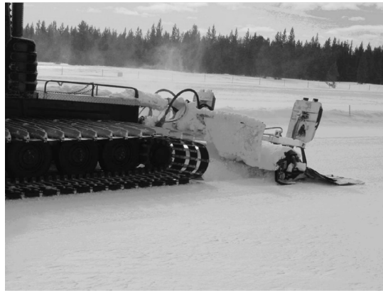
Bild 4-2: Beispiel für die Konditionierung einer Schneefahrbahn, (Bildquelle: Phettaplace, [106]).
