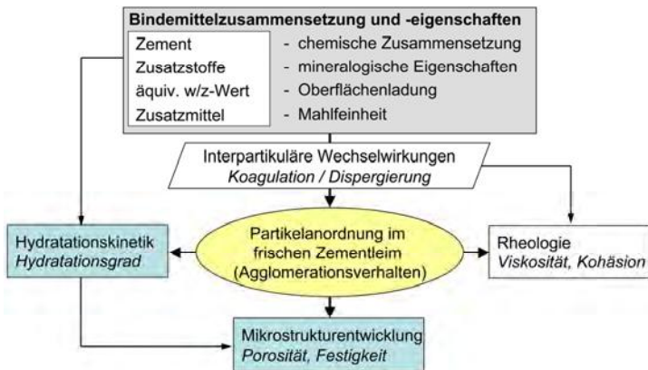
Bild 5 Einflüsse feiner Partikel auf Zementleimeigenschaften
