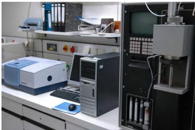
Bild 4 Chemielabor mit Kohlenstoff-Schwefel-Analysator und Infrarotspektrometer
