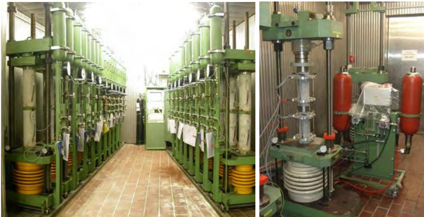
Bild 2 Kriechstände (links) und Relaxationsstände (rechts) für die Messung des Kraft-Verformungsverhaltens von Baustoffen
