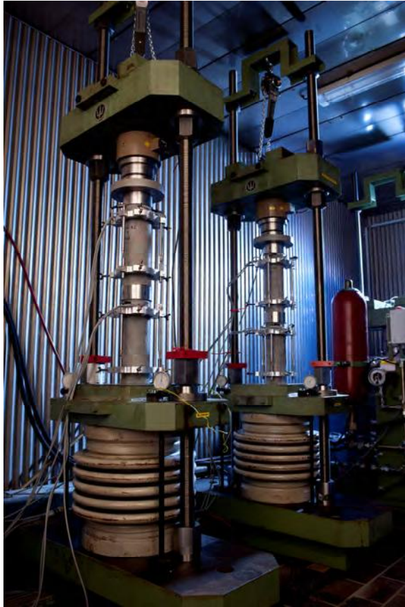
Bild 7 Relaxationsprüfstände in einem der Klimaräume der MPA Karlsruhe
