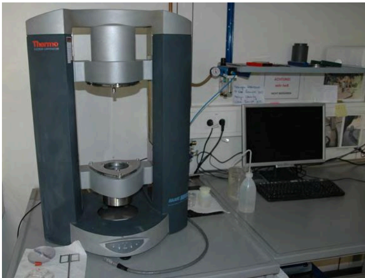
Bild 1 Rheologielabor mit zwei Hochleistungsrheometern für Untersuchungen an Zementsuspensionen und Mörteln
