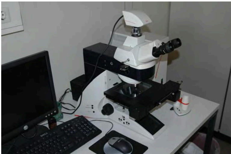
Bild 2 Mikroskopieraum mit automatischem Bildanalyse-Polarisationsmikroskop, ausgestattet mit Digitalkamera
