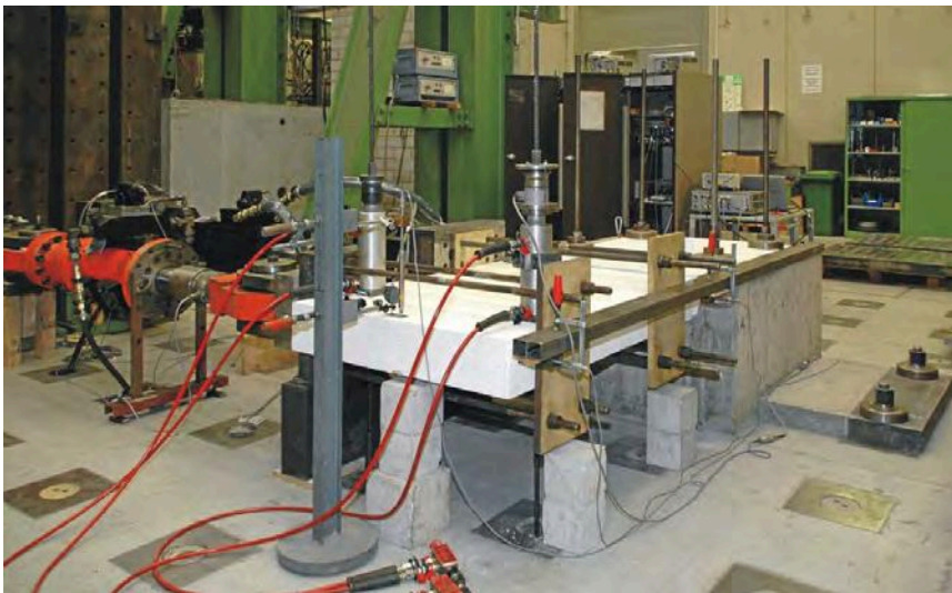
Bild 2 Prüfung eines Balkonplattenanschlusses mit mehraxialer Lasteinleitung im Rahmen von Zulassungsprüfungen auf dem Prüffeld
