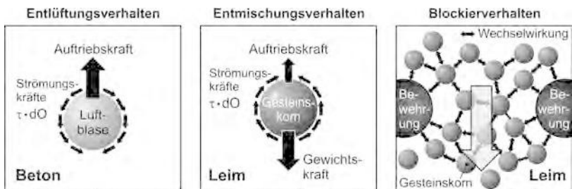
Bild 1 Schematische Darstellung der Mechanismen bei der Entlüftung (links) und Entmischung (Mitte) von Beton sowie beim Blockieren der Gesteinskörnung in engen Bewehrungszwischenräumen (rechts)
