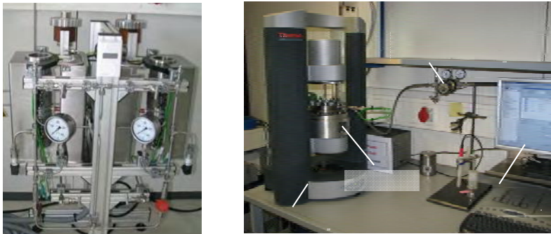
Bild 1 Autoklavensystem zur Untersuchung der Korrosionsbeständigkeit erhärteter Zementleime bei Beaufschlagung mit Kohlensäure bzw. überkritischem CO 2 (links) und rheologisches Hochdruckmesssystem für die Untersuchung des Fließverhaltens frischer Zementsuspensionen (rechts), jeweils für Temperaturen von bis zu 150 °C und Drücken bis zu 300 bar
