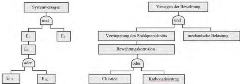
Bild 6. Schema einer Fehlerbaumanalyse, E_i = Ereignis i (links), und Übertragung auf karbonatisierungs- und chloridinduzierte Bewehrungskorrosion (rechts)
