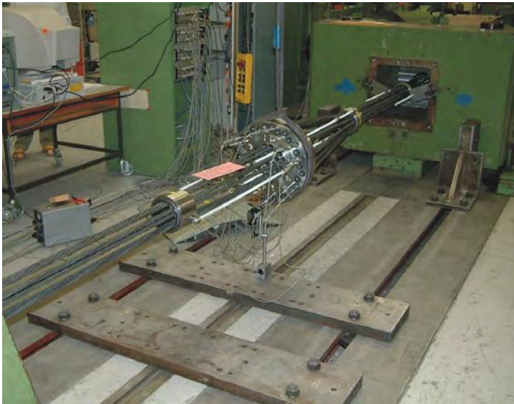
Bild 3 Zugversuch an einer Kopplung im Rahmen von Zulassungsprüfungen nach ETAG 013 für ein Spannverfahren in der liegenden Zug-Druck-Prüfmaschine ZD 3000 kN
