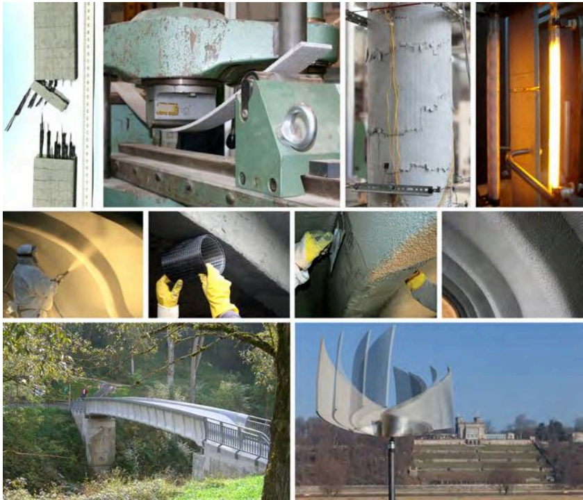
Bild 5 Textilbeton – Eigenschaften und Anwendung; oben: Grundlagenforschung im Labor; Mitte: Verstärken einer historischen Stahlbeton-Tonnenschale; unten: Segmentbrücke aus Textilbeton in Kempten und Textilbeton-Kunstwerk des Dresdner Künstlers Hans-Volker Mixsa (Fotos u. a. aus [7], [11], [12], [18])
