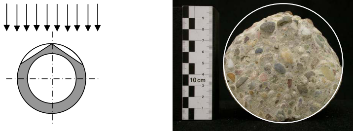
Bild 3.17: Gestaltveränderung infolge Verschleißbeanspruchung; links: an runden Profilen auftretende Gestaltveränderung in Form symmetrischer Abplattungen (Ausbildung einer Dachform) [187]; rechts: Zylinderprüfkörper nach 22-stündiger Belastung mit Verschleißgut aus Quarz mit 16 mm Größtkorn
