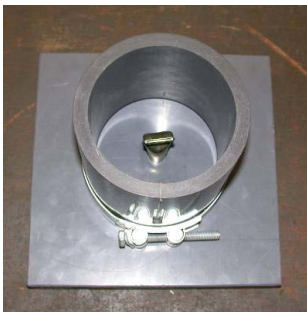
Bild A-3.5: Spezielle Schalungselemente zur Herstellung der Prüfkörper; links: Zylinder mit Gewindeeinsatz (Durchmesser/Höhe = 100 mm/100 mm); rechts: Würfel mit Gewindeeinsätzen (Kantenlänge = 100 mm)
