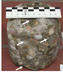
Bild 3.14: Zylinderprüfkörper nach 13-stündiger Belastung mit Verschleißgut aus Quarz mit 32 mm Größtkorn
