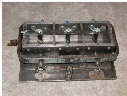
Bild A-3.5: Spezielle Schalungselemente zur Herstellung der Prüfkörper; links: Zylinder mit Gewindeeinsatz (Durchmesser/Höhe = 100 mm/100 mm); rechts: Würfel mit Gewindeeinsätzen (Kantenlänge = 100 mm)
