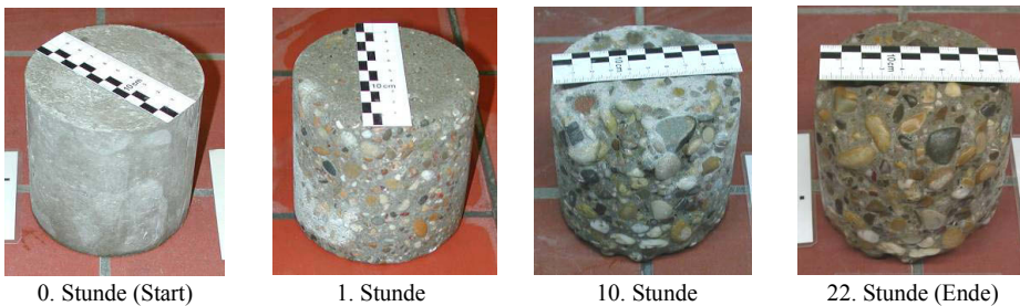
Bild 3.7: Betonabtrag an einem zylinderförmigen Betonkörper bei Verwendung von Quarzgestein (16 mm Größtkorn) als Verschleißgut
