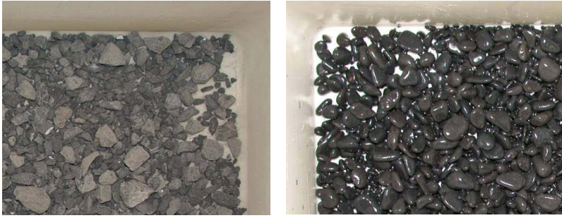
Bild 3.10: Verschleißgut Basalt vor (links) und nach dem Verschleißversuch (rechts)
