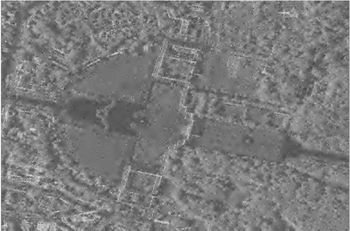
Abbildung 4.2: Logarithmiertes Amplitudenbild aus Abbildung 4.1 nach Bildverbesserung mithilfe der Laplace-Pyramide
