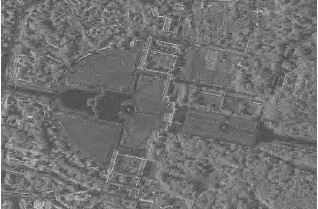
Abbildung 4.3: Logarithmiertes Amplitudenbild aus Abbildung 4.1 nach Bildverbesserung unter Verwendung von Wavelets
