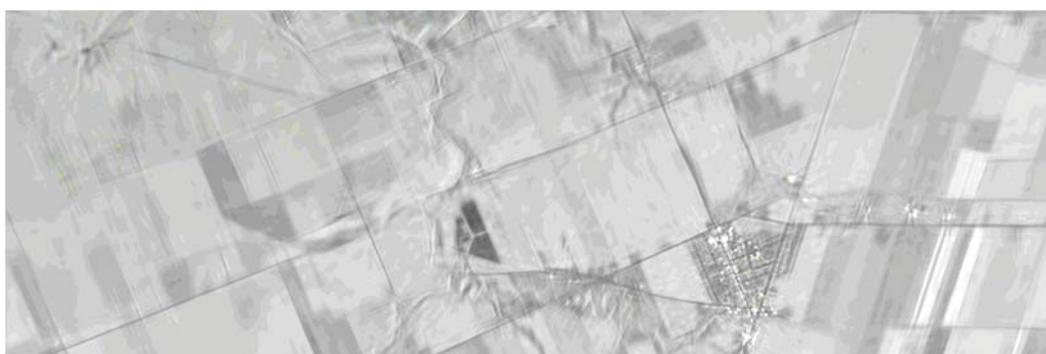
(b) Standard-Multilooking mit zusätzlicher Curvelet-Bildverbesserung
