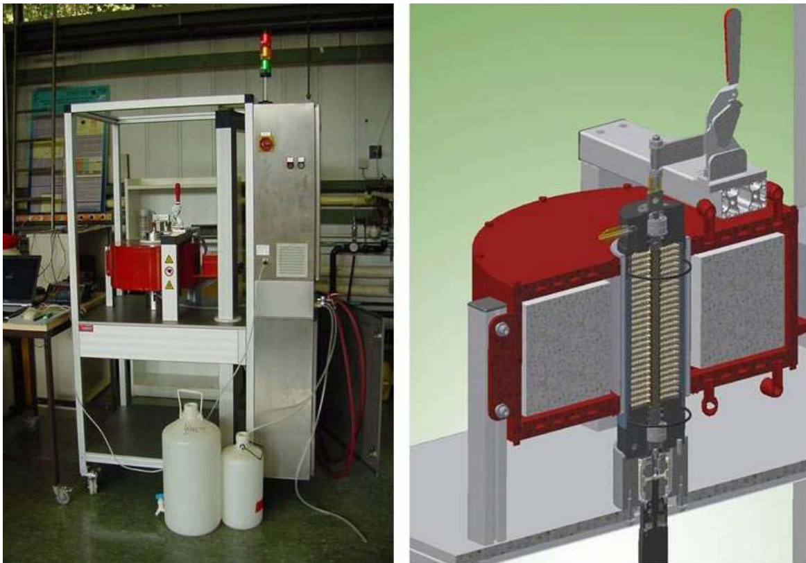
Abbildung 3.4: Photo der automatisierten HGMF-Pilotanlage inklusive Peripherie und 3D-Schnittzeichnung (© ABBIS bio process automation, Wiesbaum, Deutschland) des Elektromagneten mit integrierter Filterkammer
