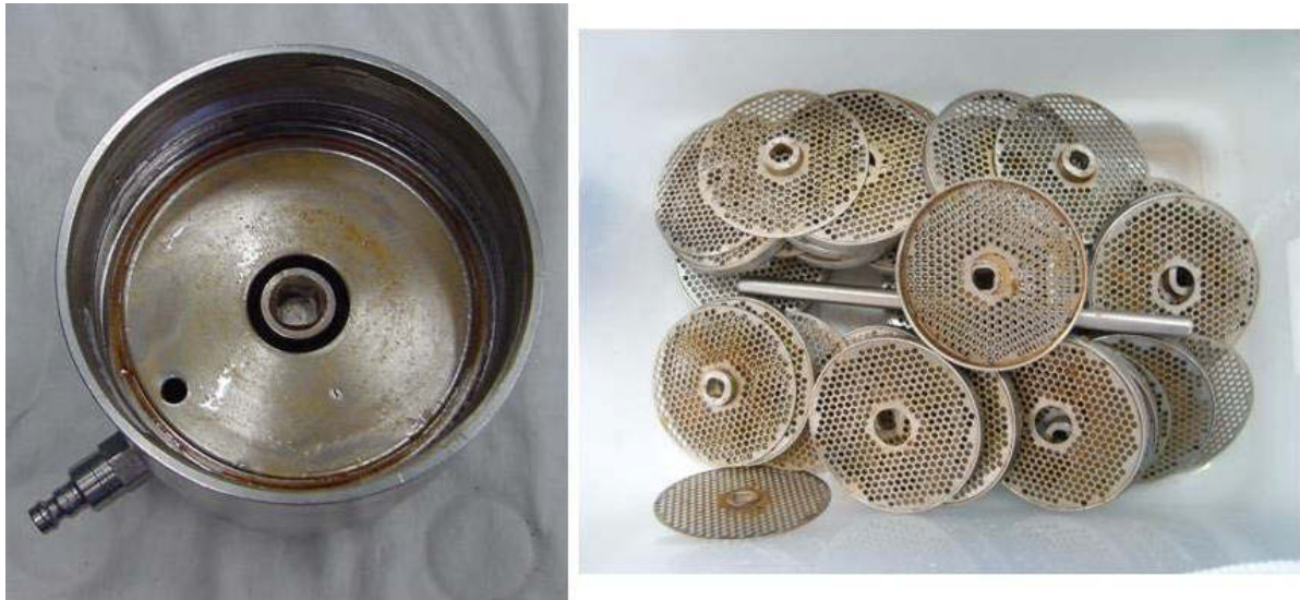
Abbildung 4.31: Deckel der Filterkammer und Filterrunden nach Ausspülen der Partikel aus dem Separator
