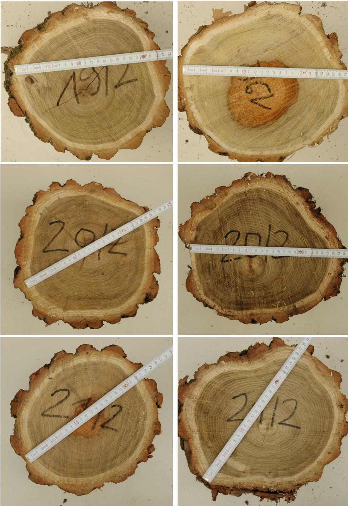
Bild A-37 (Forts.) Hirnholzflächen der beiden Referenzproben, Zopfende (links) und Stockende (rechts)
