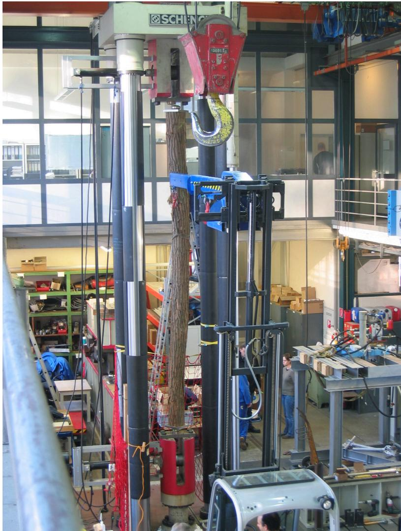
Bild 3-3 600-t-Prüfmaschine mit eingebautem Robiniendruckstab
