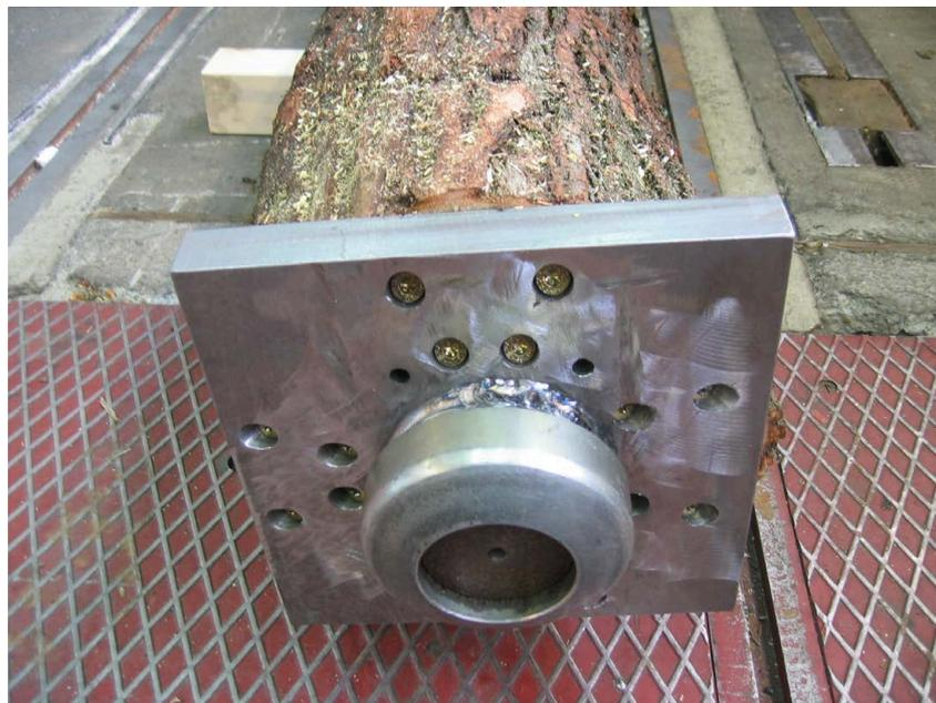
Bild A-33 Aufgeschraubte Kopf- bzw. Fußplatte mit Kalotte
