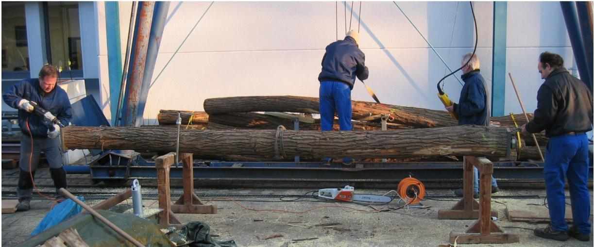
Bild A-32 Vorbereitung eines Druckstabs, Aufschauben der Kopf- und Fußplatten
