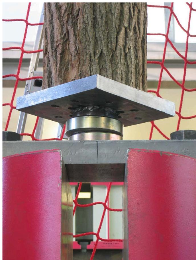
Bild A-35 Gelenkige Lasteinleitung, unten
