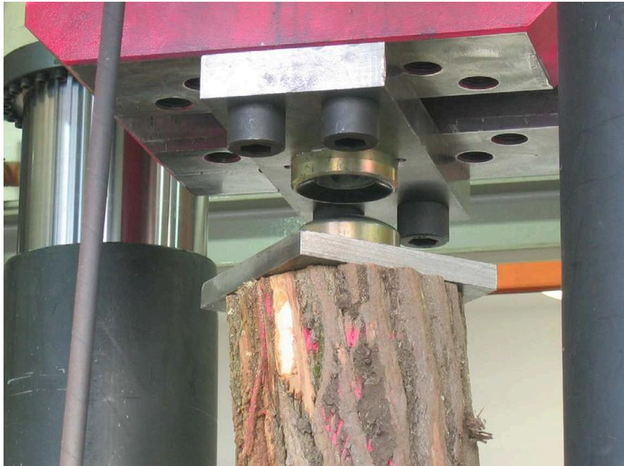
Bild A-34 Gelenkige Lasteinleitung, oben; Situation kurz vor dem Zentrieren
