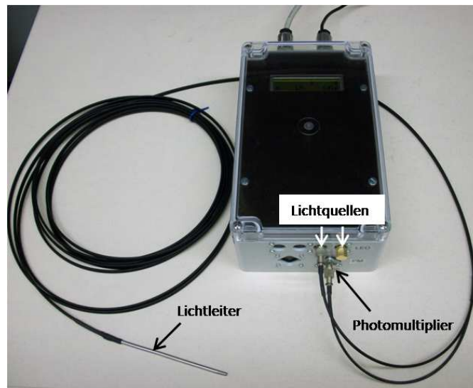
Abb. 23: Mobiles Lichtleiter-Fluorimeter mit Lichtquellen für die Anregung von Fluorescein oder GFP und einem Photomultiplier zur Detektion der Fluoreszenz-Intensitäten
