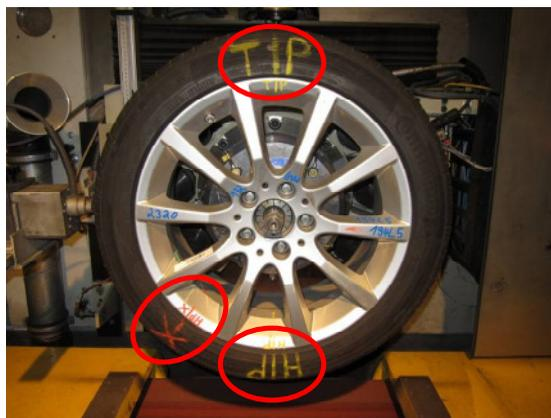
Abbildung 27: Versuchsreifen mit markierten Anregungspunkten (HP; TP; HP-X)
