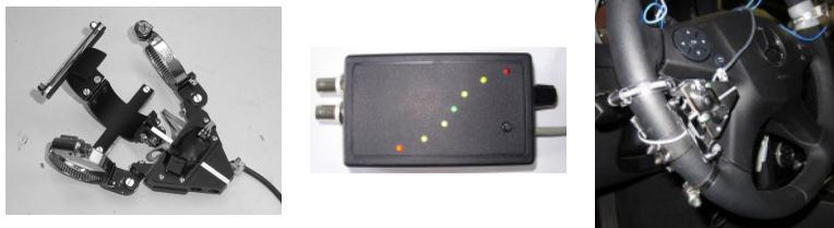
Abbildung 11: Lenkradhaltekräftmesssystem (LHKMS): Messkopf (links); Systemadapter (mitte); System verbaut an C-Klasse-Lenkrad (rechts)
