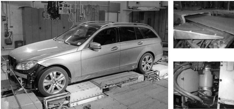
Abbildung 16: Versuchsfahrzeug (C-Klasse) aufgespannt auf Flachbahn-Fahrzeug-Prüfstand (links); Flachbahneinheit (rechts oben); Hydropulszylinder (rechts unten)
