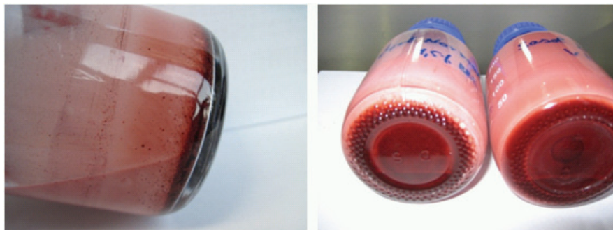
Abb. 6-10: Dunkelrot gefärbtes Sediment am Boden von pektinhaltigen W 1 /O-Emulsionen mit Heidelbeerextraktanteilen von mehr als 0,5 % in der W 1 -Phase.
