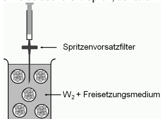
Abb. 3-3: Schematischer Aufbau der durchgeführten Freisetzungsversuche.
