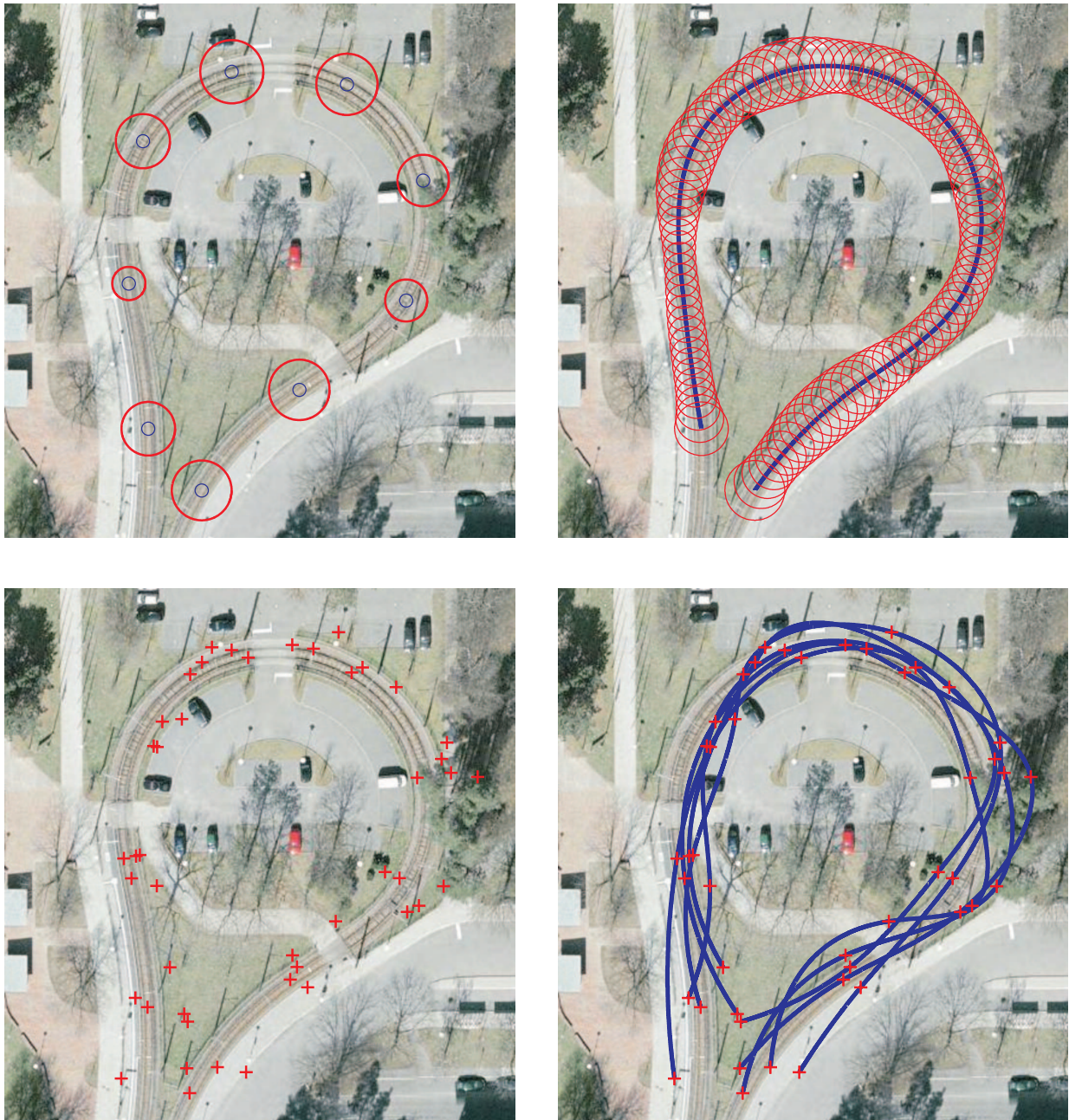
Bild 3.4: Veranschaulichung der Interpolation von M = 9 Stützstellen \mathbf{p}_i \in \mathbb{R}^2 : Basierend auf den unsicheren Positionen (links oben) ergibt sich der erwartete kontinuierliche Verlauf (rechts oben) in blau und die Unsicherheit des Verlaufs durch ausgewählte Kovarianzellipsen entlang der Kurve in rot. Zusätzlich sind 5 Realisierungen der Stützstellenverteilung (links unten) und die entsprechende Kurvenschar (rechts unten) zu sehen.
