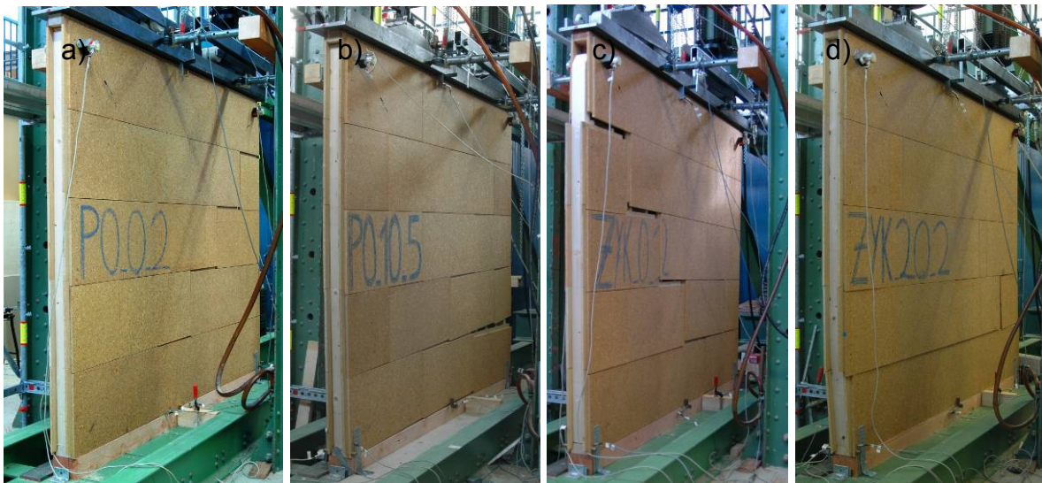
Bild 4-29 Versagensbilder der Einzelement-Bauweise: a) treppenförmiges Versagen (monoton, ohne Auflast), b) Zugversagen erste Fuge (monoton, Auflast 10 kN/m), c) treppenförmiges Versagen (zyklisch, ohne Auflast), d) Schubversagen der ersten Fuge (zyklisch, Auflast 20 kN/m)
