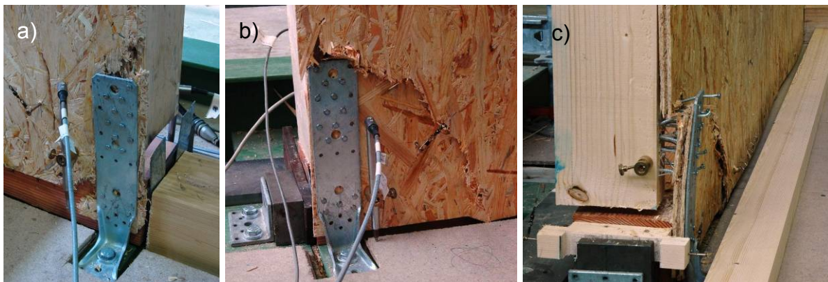
Bild 4-31 Versagen Beplankung a) auf Zugseite, b) auf Druckseite, c) Auszug VM an Zuganker und Beplankung
