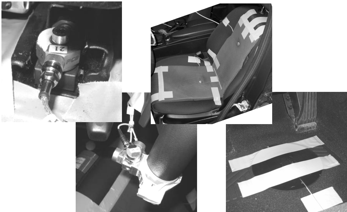
Abbildung 4.9: Messpunkte im Fahrzeug (von links nach rechts): Sitzkonsole vorne links, Lenkrad, Sitz- und Lehnenmessmatte, Fußraum
