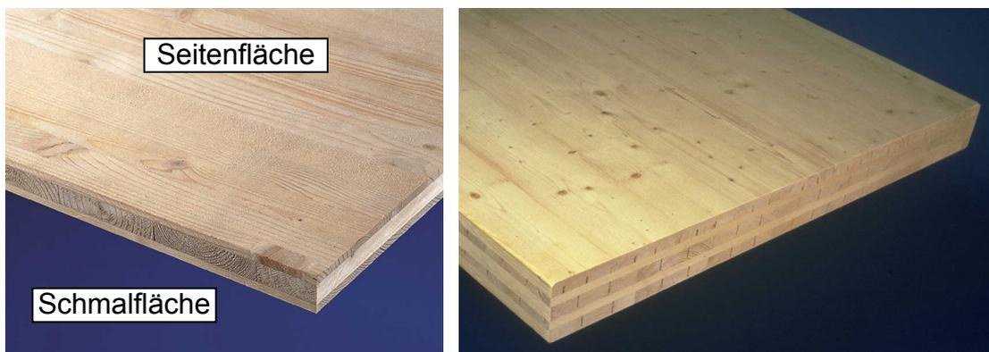
Bild 5-1 Verschiedene Brettsperrholzprodukte mit Definition von Seiten- und Schmalfläche (Bilder: Informationsdienst Holz)
