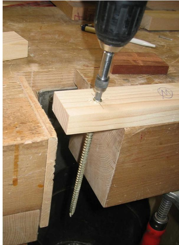
Bild 3-74 Vermeidung von Zwängungen und Reibung beim Einschrauben durch auskragende Prüfkörperanordnung
