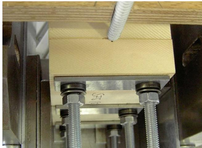
Bild 3-9 Lagerung des Prüfkörpers
