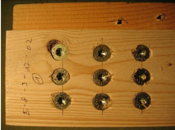
Bild 10-75 Einschraubversuch der Reihe E-8-3-12-2
