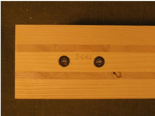
Bild 10-78 Einschraubversuch 12-5-128-C-2
