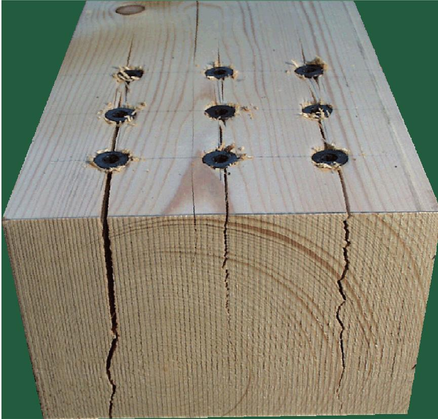
Bild 2-2 Spaltversagen eines Kantholzes beim Eindrehen von Schrauben
