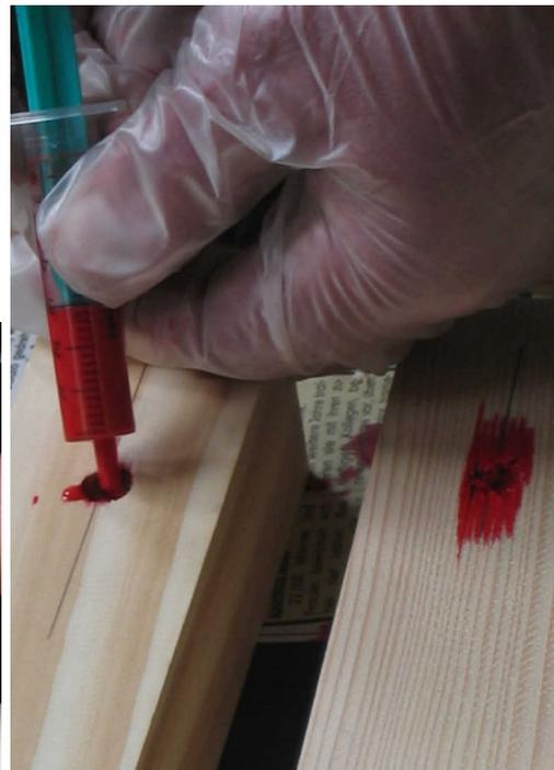
Bild 3-75 Abdichten der Prüfkörper und Einbringen der Farbe
