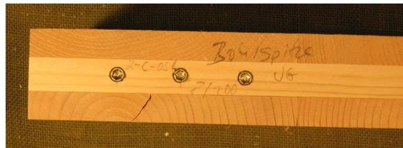
Bild 10-79 Einschraubversuche 8-3-60-C-1 (links) und 8-3-60-C1-1 (rechts)
