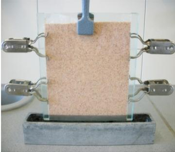
Abb. 26: Hele-Shaw Zelle aus Glas gefüllt mit Quarzsand und eine Alu-Schale als Reservoir für verschiedene Flüssigkeiten
