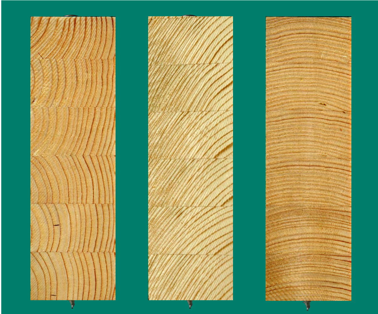
Bild 3-8 Prüfkörpervarianten I, II und III, abweichend zur Darstellung bestehen die Prüfkörper aus sieben bzw. acht Lamellenlagen
