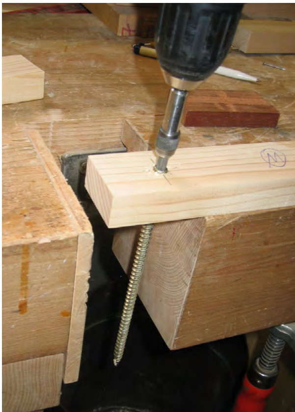
Bild 4-2 Versenken des Kopfes, nach einer Wartezeit wird die Schraube wieder herausgedreht
