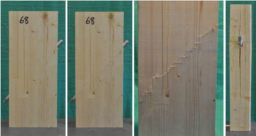
Bild 4-6 16 mm Bohrung (Typ 2) (links: vor dem Versuch; 2.v.l.: nach dem Versuch; 2.v.r.: Detail nach dem Versuch; rechts: Aufspalten)
