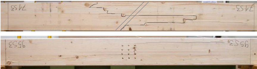
Bild 4-14 Versagensbild des Typs 2 (oben) und des Typs 3 (unten)
