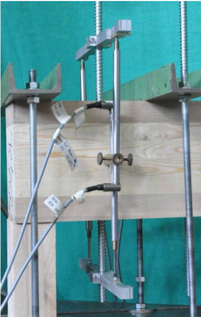
Bild 7-1 Versuchsaufbau - Bestimmung der Ausziehtragfähigkeit
