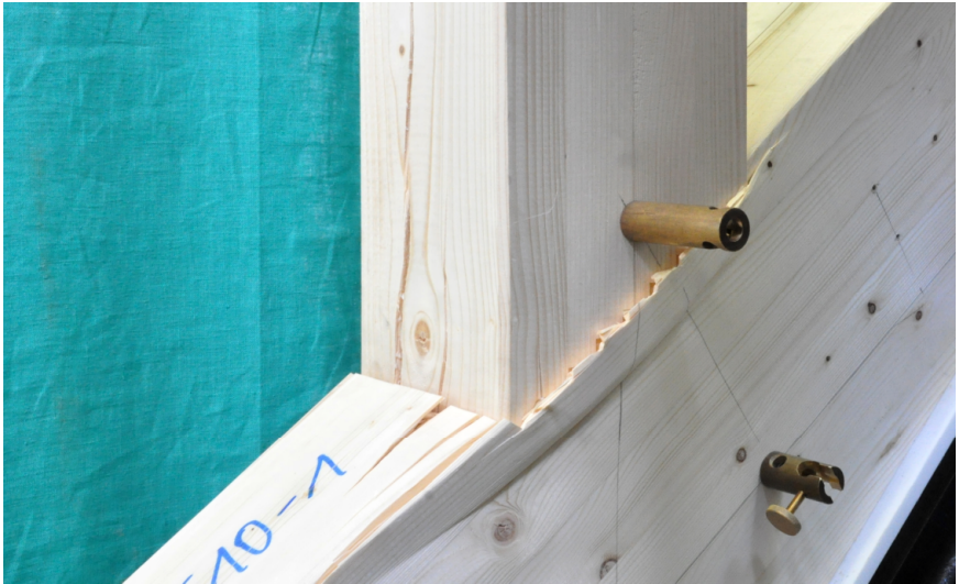
Bild 8-15 Querdruckversagen Reihe 10 mit \alpha = 55^\circ
