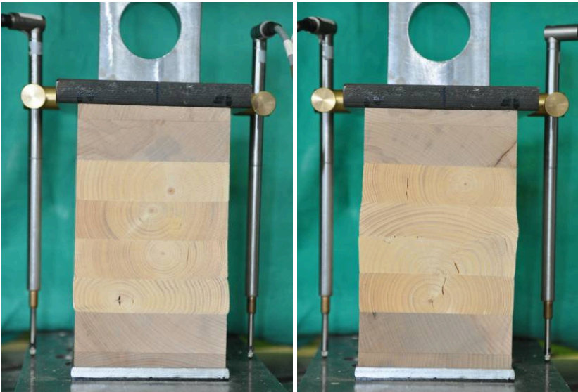
Bild 9-5 Querdruckversagen (links: Versuch 5, mit Verstärkung; rechts: Versuch 4, ohne Verstärkung)
