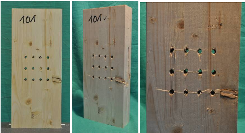
Bild 4-7 Schlitzblech und Stabdübel (Typ 3) (links: vor dem Versuch; Mitte: nach dem Versuch; rechts: Detail nach dem Versuch)
