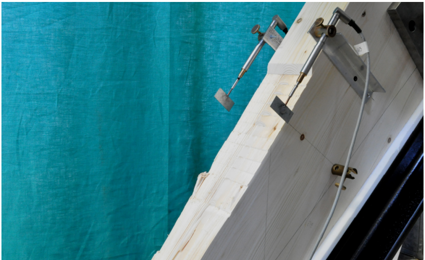
Bild 8-16 Scherversagen Reihe 9 mit \alpha = 35^\circ
