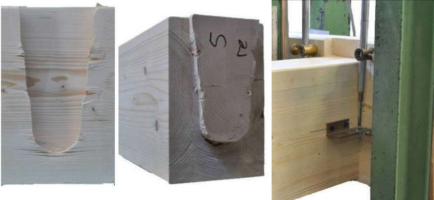
Bild 6-6 Plastische Deformation im Verbindungsbereich (links und Mitte: Reihe 1.2; rechts: Reihe 1.1.1)
