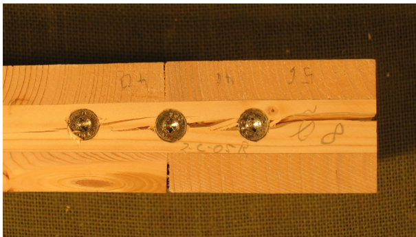
Bild 10-79 Einschraubversuche 8-3-60-C-1 (links) und 8-3-60-C1-1 (rechts)
