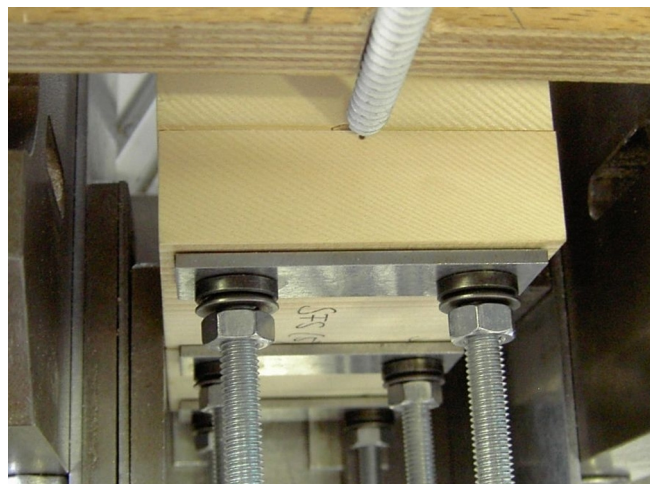
Bild 3-8 Versuchseinrichtung, Schablonen zur Führung der Schraube
