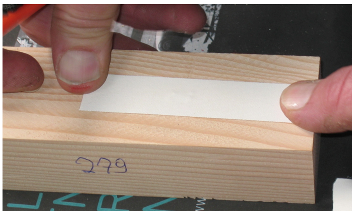
Bild 3-75 Abdichten der Prüfkörper und Einbringen der Farbe
