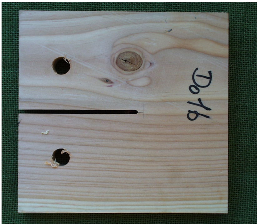
Bild 2-4 CT-Probe von Blaß und Schmid (2002) mit durch Spachtel erzeugtem Anriss
