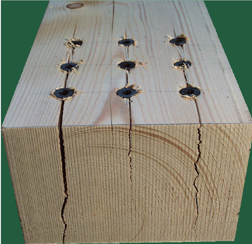
Bild 2-2 Spaltversagen eines Kantholzes beim Eindrehen von Schrauben
