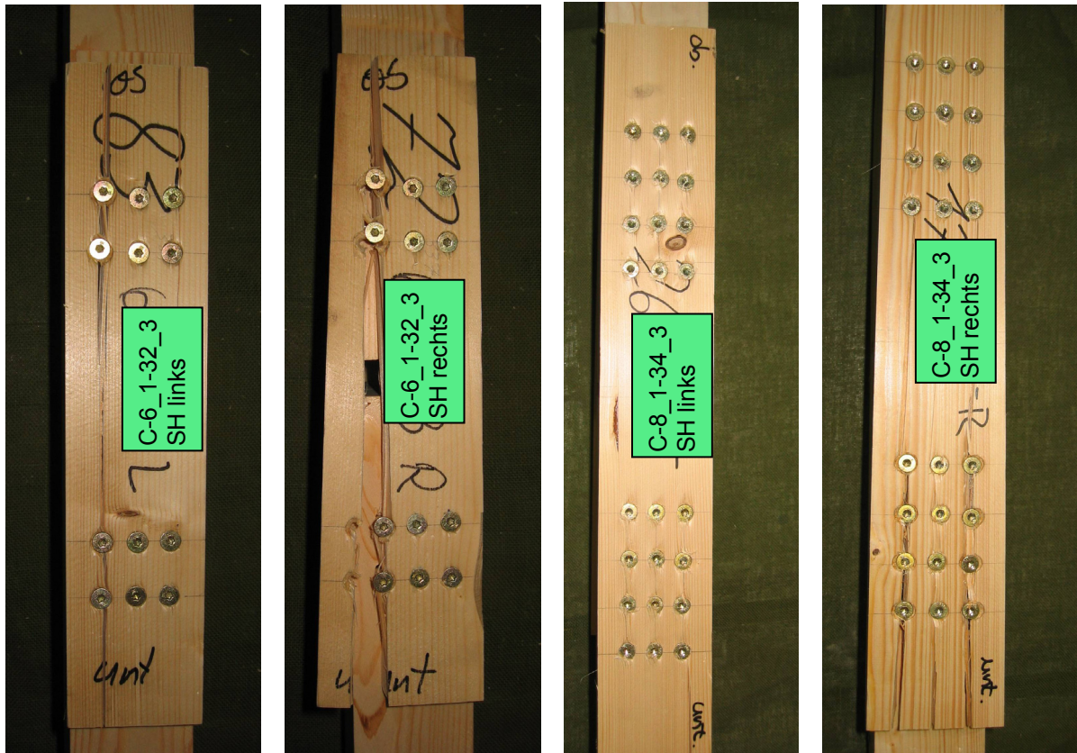
Bild 10-61 Typisches Versagen durch Aufspalten der Seitenhölzer in den Versuchsreihen mit Schraubentyp C, hier: Versuch C-6_1-32_3 und C-8_1-34_3
