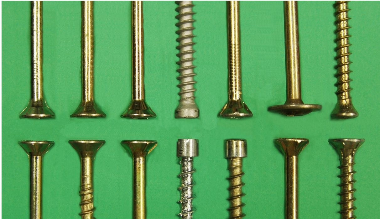
Bild 3-3 Ausbildung von Schraubenköpfen bei unterschiedlichen Typen selbstbohrender Holzschrauben
