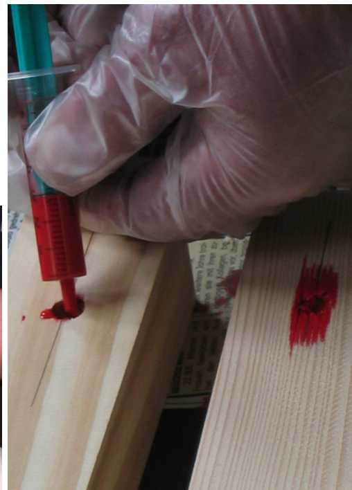
Bild 3-75 Abdichten der Prüfkörper und Einbringen der Farbe
