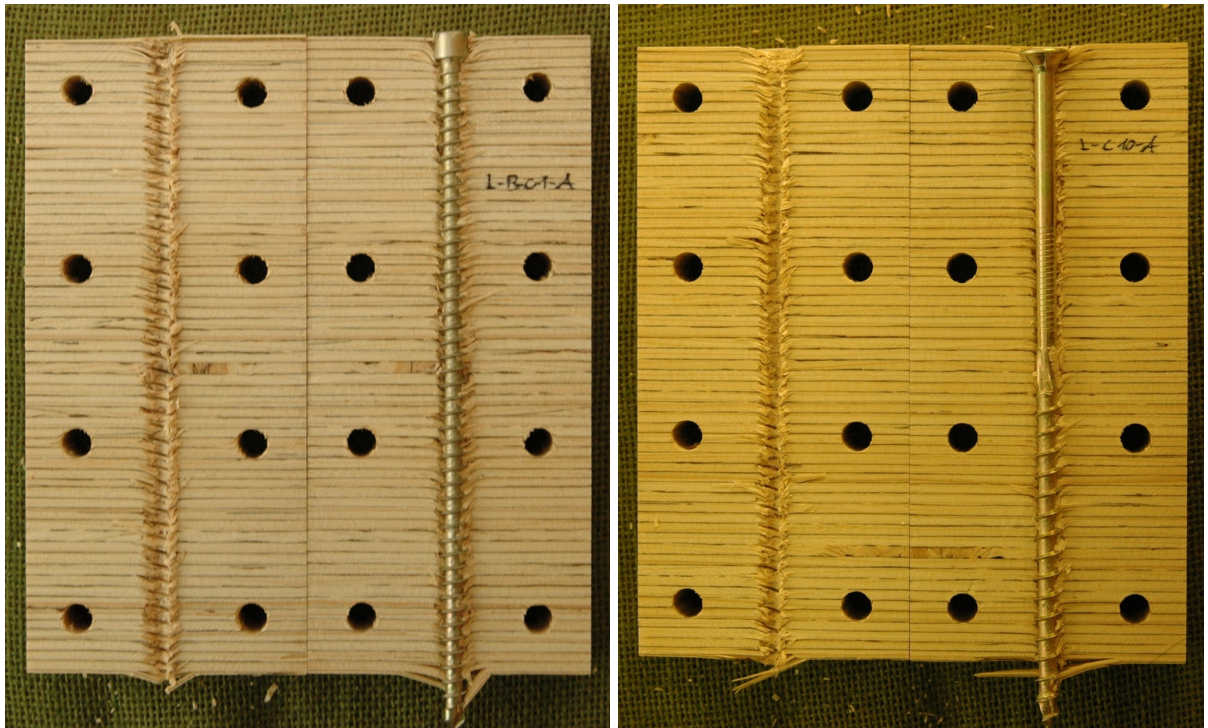
Bild 3-67 Geöffnete Prüfkörper nach der Versuchsdurchführung, hier: Prüfkörper von Versuchen mit Schraubentyp B und C
