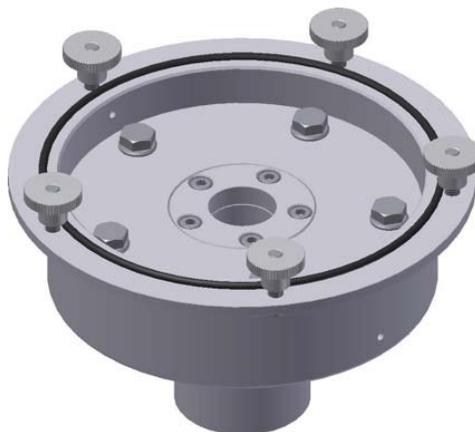
Abb. 7-5: CAD-Zeichnung der offenen Diffusionskammer
