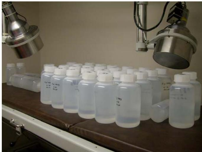
Abb. 7-8: Flaschenphantom K-40 in Standardmessposition im Ganzkörperzähler
