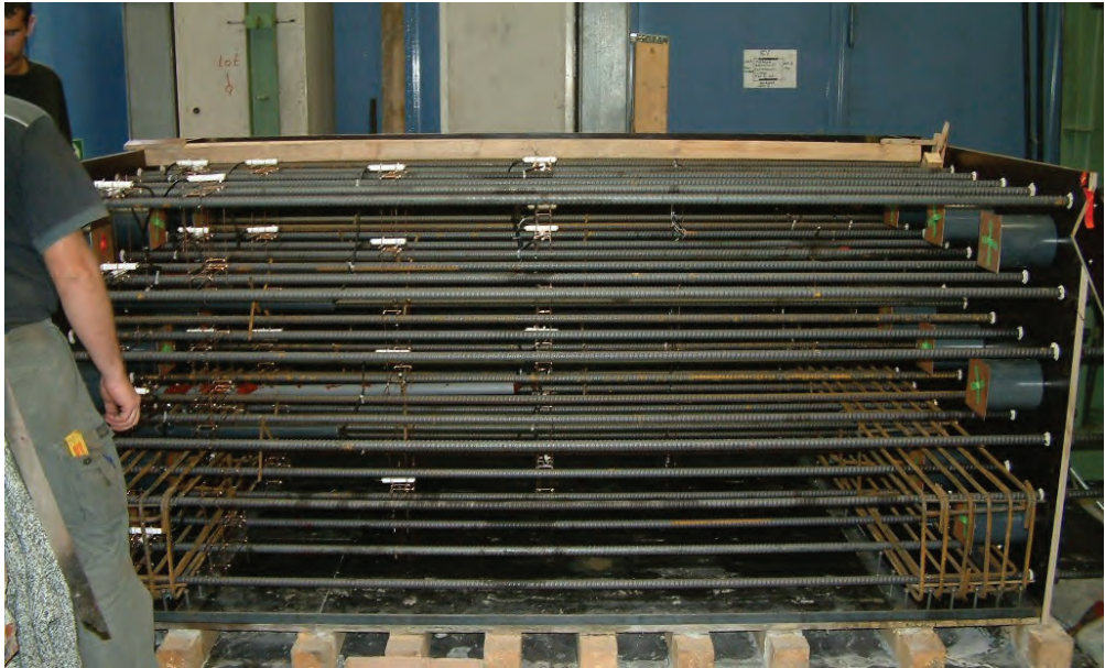
Abb. 3-11 Ausführung mit Längsbewehrung
