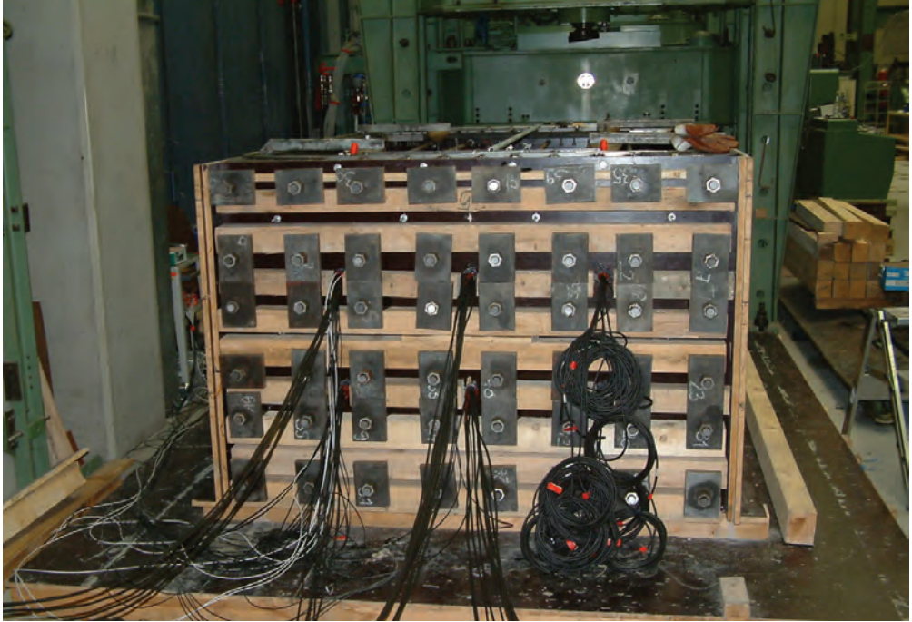
Abb. 3-17 Ausführung der Kabel aus dem Versuchskörper
