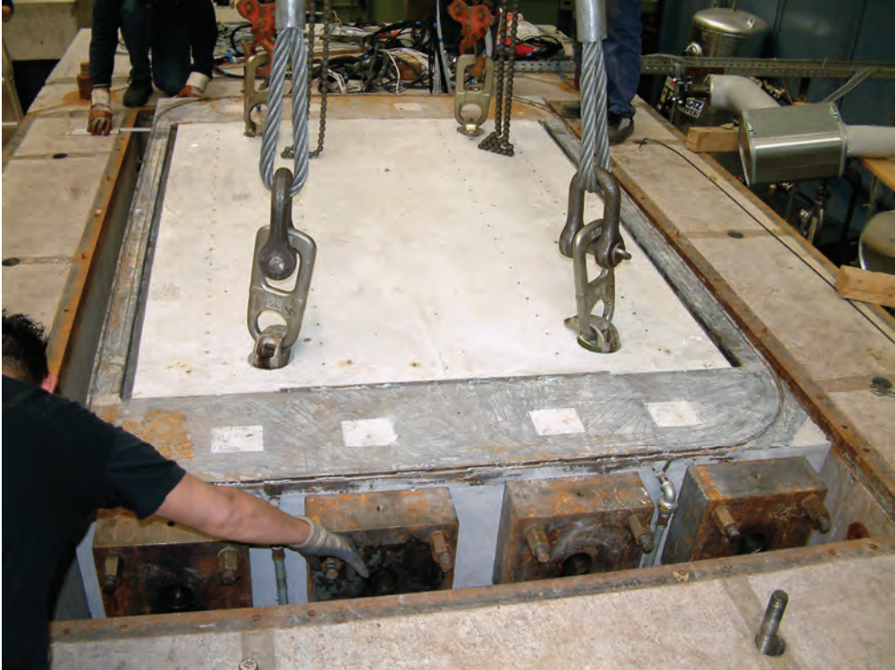
Abb. 3-5 Absenken des Versuchskörpers in den Lastrahmen
