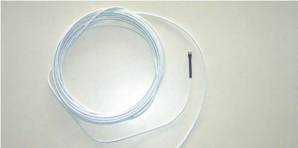
Abb. 4-10 Gekapselter PT100 für den Einsatz in Beton
