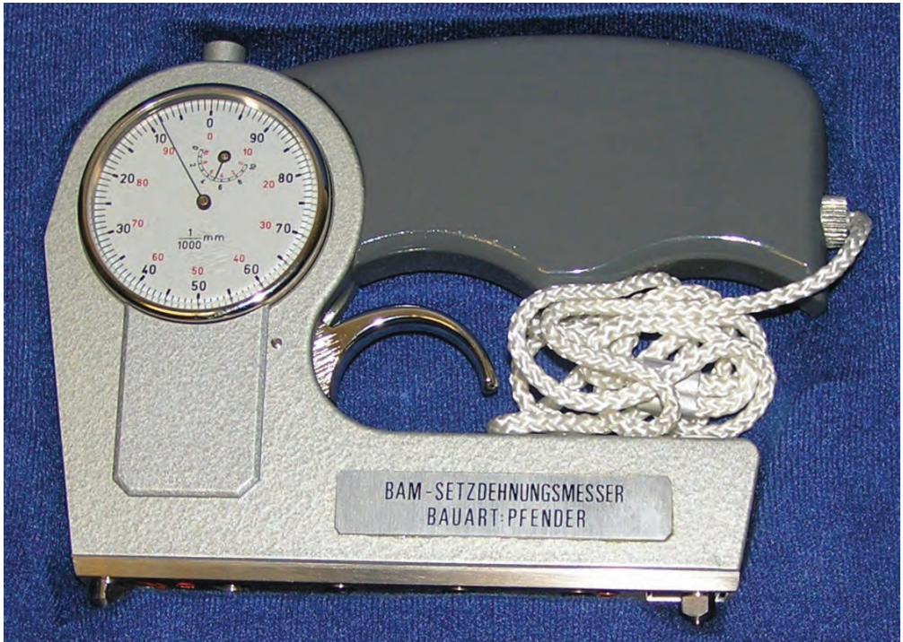
Abb. 4-13 Setzdehnungsmesser vom Typ BAM Pfender
