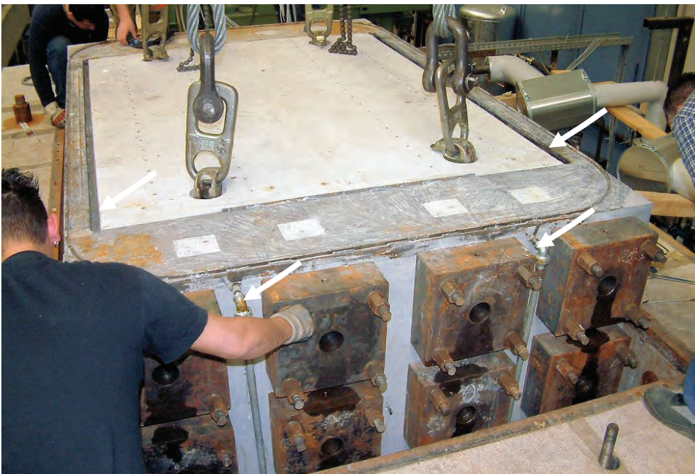
Abb. 3-13 Kondensatableitungsrohr zwischen Koppelplatten
