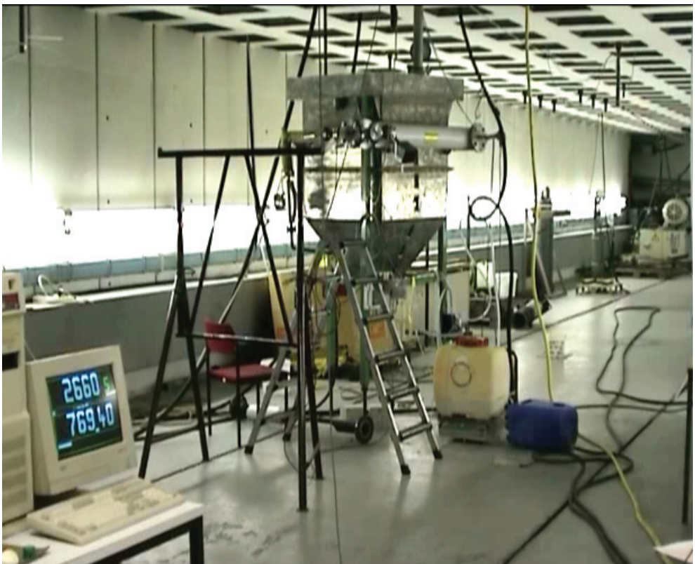
Abb. 4-16 Durchflussmessung mit Rechner (li.) und Waage (re.)
