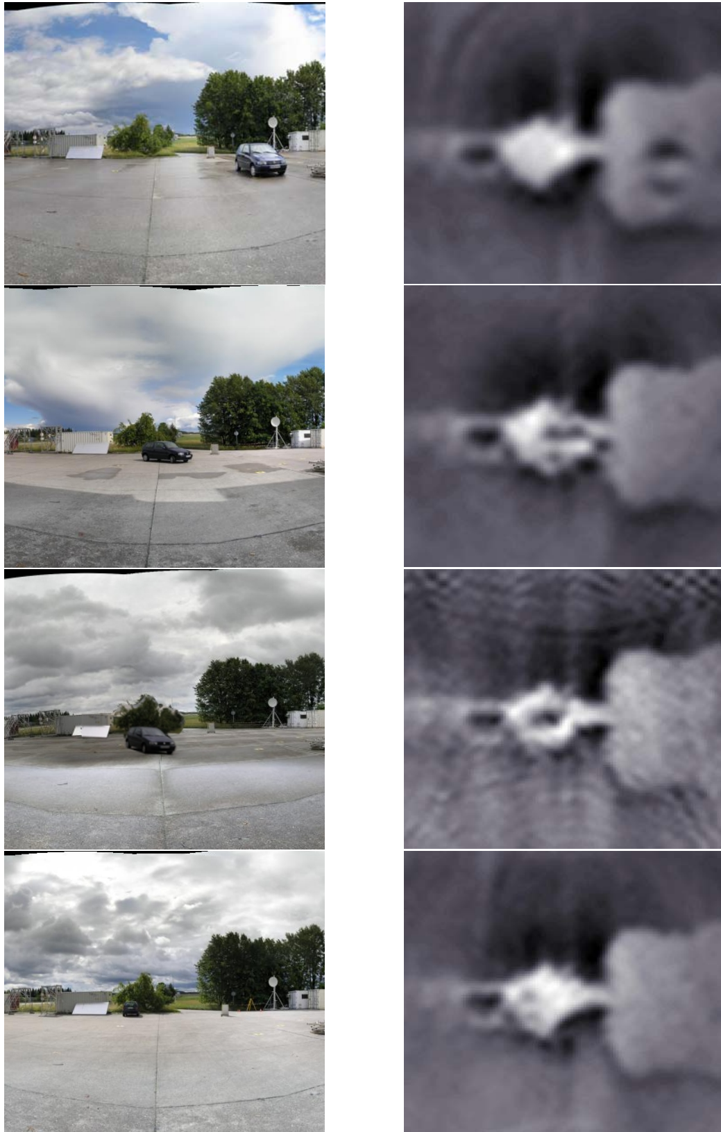
Abbildung 7.12: Vergleich verschiedener Variationen der Szene 2. Dargestellt sind die jeweiligen spektralen Mittelwerte der sieben aufgenommenen Frequenzen zwischen 2,6 GHz bis 5,8 GHz der rekonstruierten Strahlungstemperaturverteilungen (rechts) und die Fotografie der Szene (links).
