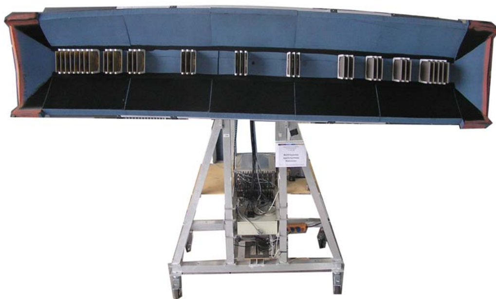
Abbildung 6.8: Fotografie des ANSAS-Instruments mit absorbierender Abschirmung der Antennenrückseiten.
