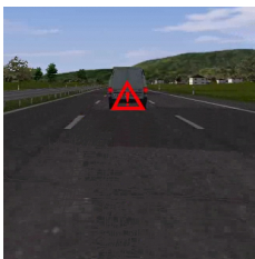
Abbildung 6.2: Heckprojektion Kollisionsanzeige Warndreieck
