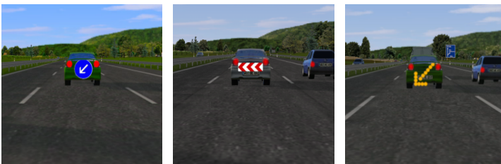
Abbildung 6.4: Heckprojektion Ausweichanzeige Links: Vorgeschriebene Vorbeifahrt Mitte: Richtungstafel in Kurven Rechts: Blinkpfeil einer fahrbaren Absperrtafel
