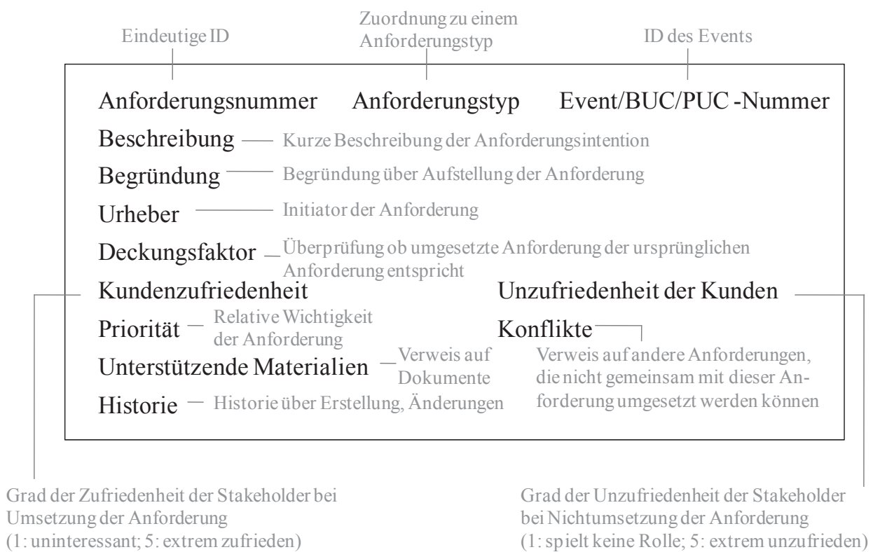
Abb. 3.22: Aufbau des Atomic Requirements Shell in Anlehnung an Robertson und Robertson (Robertson & Robertson, 2010, S. 5)
