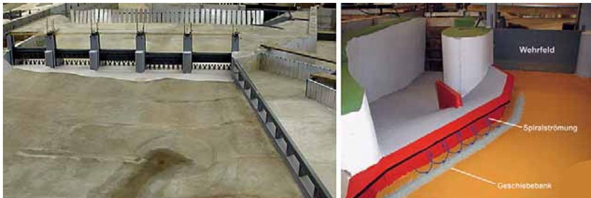
Abb. 4.4: Physikalisches Modell RADAG und optimierte Kontur des Zulaufbereichs im Ausführungsvorschlag
