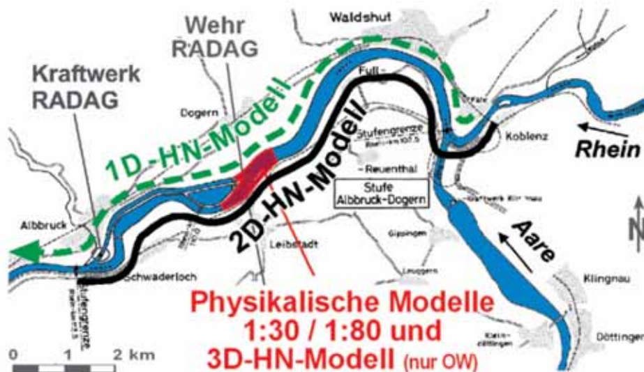
Abb. 4.3: Lageplan Untersuchung Wehrkraftwerk
