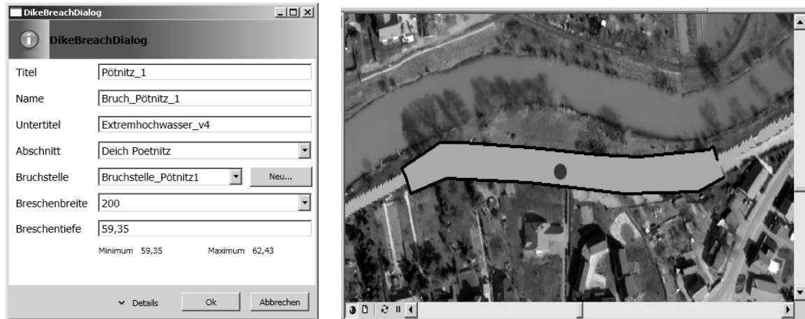
Abb. 6.17: Menügeführte Deichbreschenerstellung (links) und Darstellung des Bruchpunkts und –bereichs im GIS (rechts)
