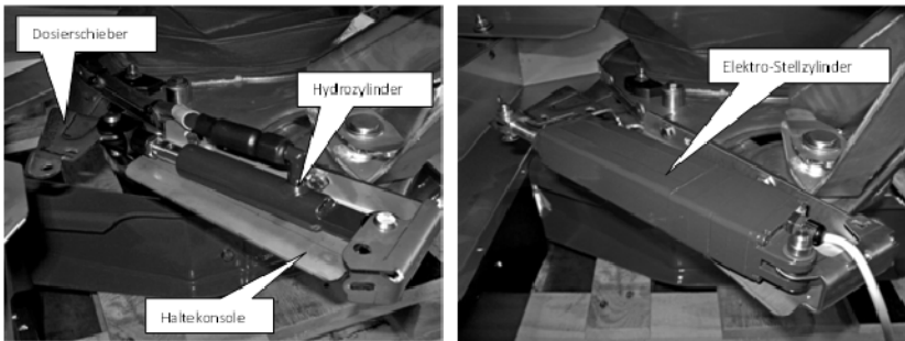
Abb. 2: Gegenüberstellung Dosierfunktion hydraulisch und elektrisch
