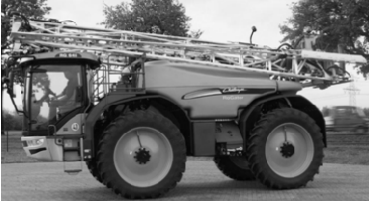
Abb. 1: Mobile Arbeitsmaschine mit hydropneumatischen Lenkungs- und Federungssystem
