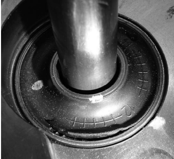
Ablösung am Außendurchmesser bei allen 4 Buchsen
