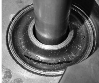
Abb.8: Buchsen Schäden nach Dauerlauf
