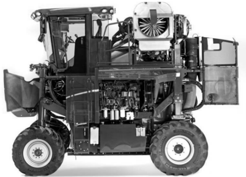
Abb. 4: Traubenvollernter Serie 6000 mit geöffneten Wartungskappen
