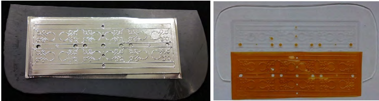
Abb. 3.7.: Heißgeprägte Aluminiumfolie auf einer PMMA Trägerschicht (links) und ein Polyimid Bauteil, das mit einer PC Trägerschicht strukturiert wurde (rechts).
