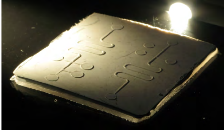
Abb. 3.5.: Mikropprägung in keramischem Feedstock auf einem Polyethylen-Träger, der die Entnahme des Bauteils von der rauen Substratplatte ermöglicht. Der sogenannte Grünling wird anschließend entbindert, pyrolysiert und gesintert.
