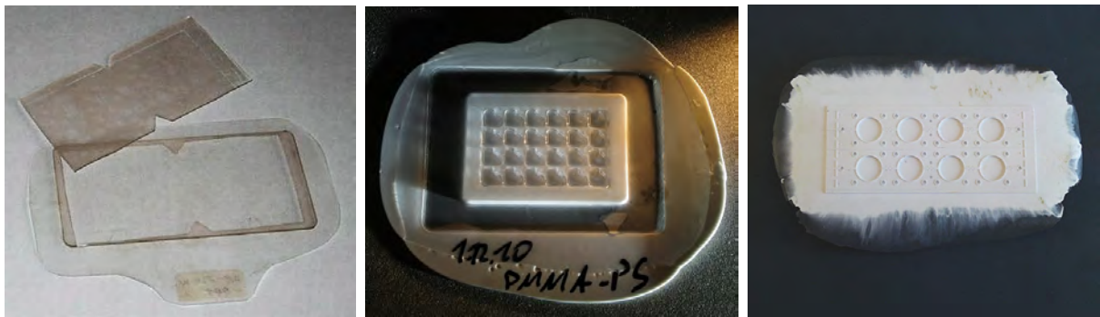
Abb. 3.11.: Die möglichen Varianten bei der Verbund-Prägung von unterschiedlichen Halbzeugen: Entweder zeichnet sich eine klare Schichttrennung ab, so dass kein Mehrkomponentenbauteil erzeugt werden kann, wie im Falle von PMMA mit COC (links); es bildet sich ein Mehrkomponentenbauteil, das aufgrund von Haftung ein festes Bauteil ausbildet, unter Kraft jedoch wieder getrennt werden kann, wie aus transparentem PMMA und weißem PS (mitte); oder es bildet sich ein fester Materialverbund, der sich mechanisch nicht mehr voneinander trennen lässt, wie aus weißem PC und schwarzem PVC (rechts)
