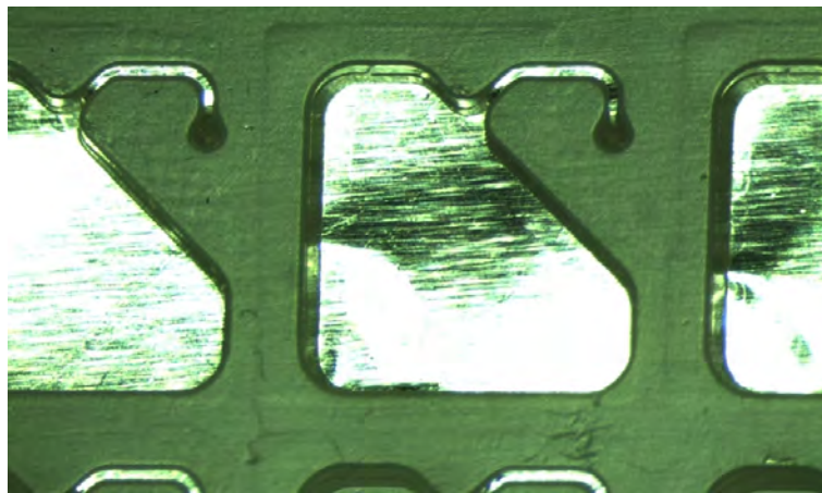
Abb. 6.6.: Detailaufnahme eines mittels Mehrkomponentenprägen hergestellten DWPs. Im Reservoirbereich und dem Kanal wurde eine Folie aus Aluminium eingeprägt, die als Spiegelfläche während dem Prägevorgang integriert werden kann.
