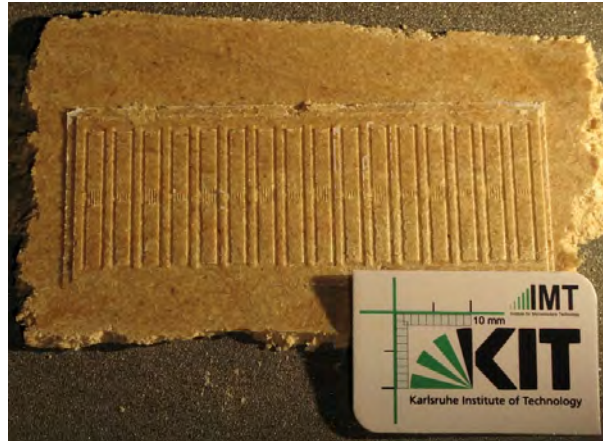
Abb. 3.4.: Heißgeprägtes WPC-Bauteil auf einer Stahlsubstratplatte mit ausgerissenen Bereichen an den Strukturen unter 200\ \mu\text{m}
