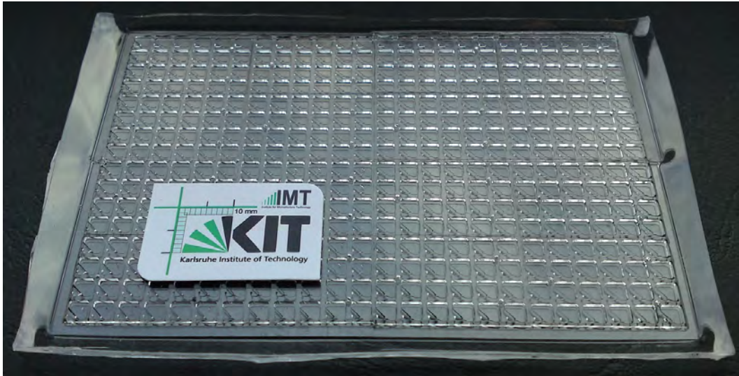
Abb. 6.5.: Abformung einer DWP mit 384 Wells in PMMA im Mikrotiterplattenformat
