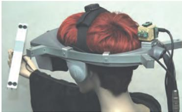
*Stereo-Head-Mounted-Display, das mit Mikrofonen und einem Gyroskopwürfel ausgestattet wurde, und ein Handtracker, bestehend aus 4 Mikrofonen*
