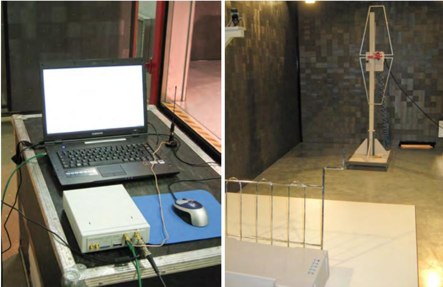
Die Bilder zeigen einen Versuchsaufbau zum experimentellen Nachweis der Existenz eines Abstrahlungsseitenkanals des von uns implementierten Funkschlüsselaustauschverfahrens. Durchgeführt wurden die Versuche mit einer anechoischen Kammer bei der Firma Micronas in Freiburg.
