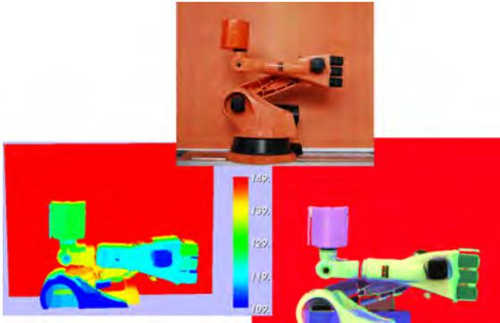
*Oben: Von einer RGB-Kamera aufgenommenes Bild der Szene. Links: Tiefenrekonstruktion durch Fusion der Spektral- und Stereoserie. Die Skala zeigt die relative Entfernung in mm. Rechts: Falschfarbendarstellung als Ergebnis der Spektralfusion.*
