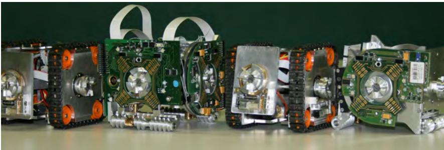
*Verschiedene Prototypen der selbstständig rekonfigurierbaren Roboter aus Replicator und Symbion (mit Kupplung, Elektronik teilweise installiert)*
