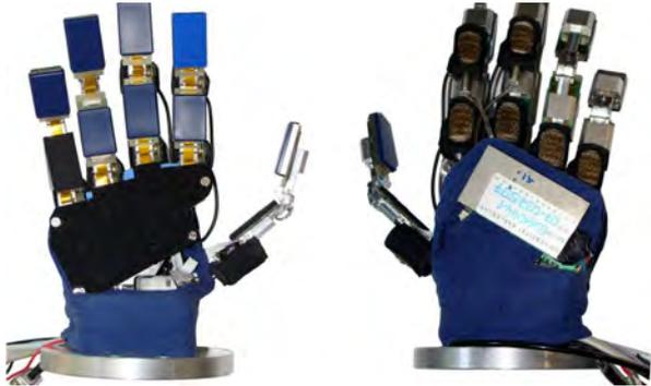
Diese ermöglichen, dass die taktilen Sensorebenen der Hand sich der Objektoberfläche anpassen und zusätzliche Information über die Objektform sammeln.
