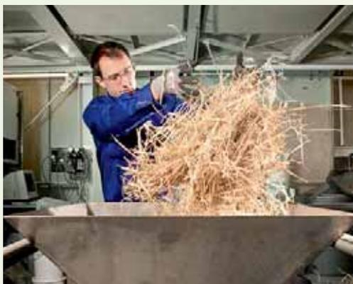
*Mechanische Vorbereitung der Biomasse: Bevor die trockenen Strohreste in die Pyrolyse kommen, müssen sie zerkleinert werden*
