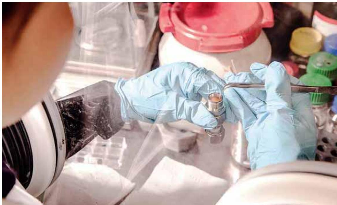
*Zusammenbau der Batteriezellen in der Argon-Box*
