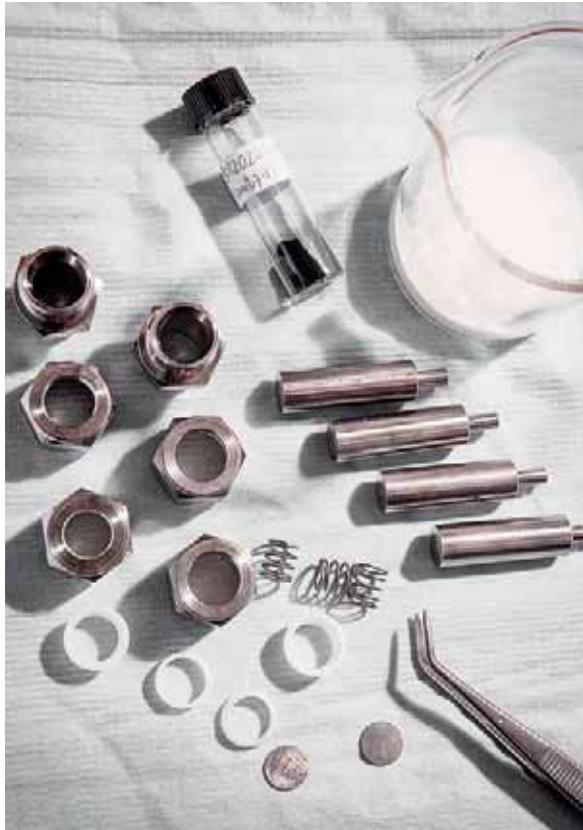
Bauteile für Batteriezellen im Labormaßstab
