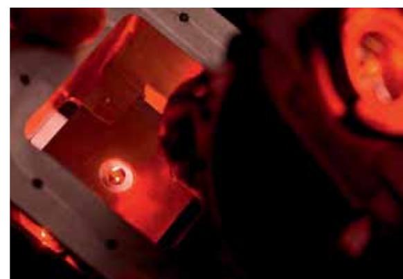
*Die dreidimensionalen Nanostrukturen für die Tarnkappe werden mittels eines roten Laserstrahls in einen Photolack geschrieben*
