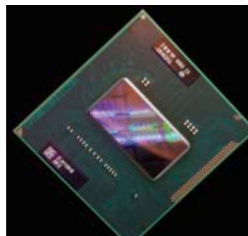
*Mehrere Prozessoren arbeiten auf einem Chip. Wenn sie parallel rechnen, sind sie schneller*
