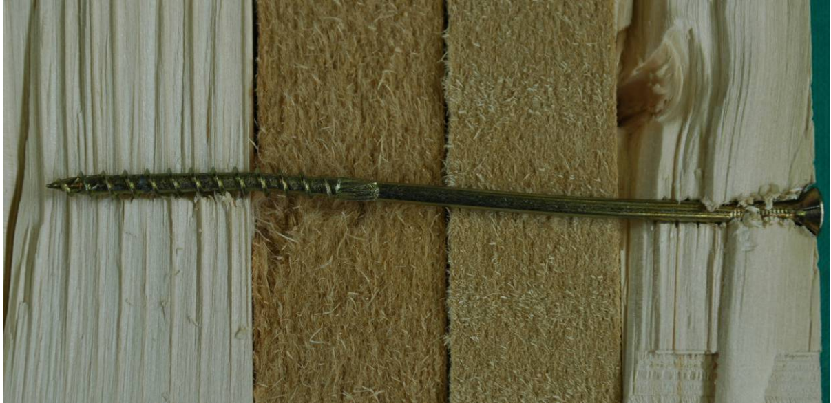
Bild 7-23 Geöffneter Versuchskörper (Dämmschicht 1 x 40 mm) nach dem Versuch
