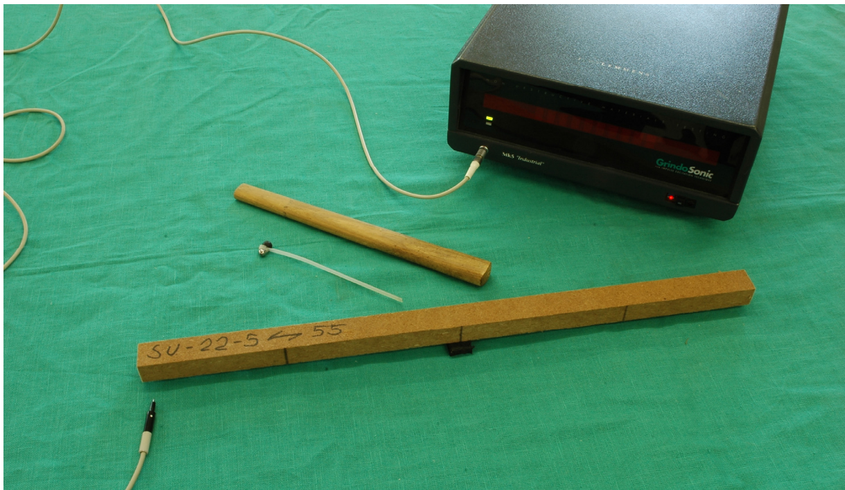
Bild 11-2 Versuchsaufbau für die Ermittlung der dynamischen Elastizitätsmoduln von Holzfaserdämmplatten
