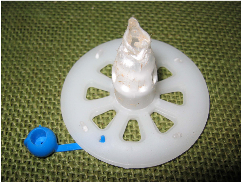
Bild 6-9 Typisches Versagen der speziellen Schraube in der UDP 2_d_I – Durchziehen der Schraube durch den Halteteller
