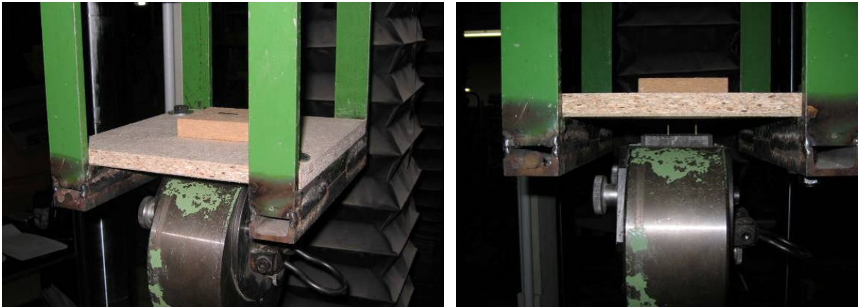
Bild 6-1 Versuchseinrichtung für die Durchführung von Rückendurchziehversuchen mit Breitrückenklammern in Holzfaserdämmplatten
