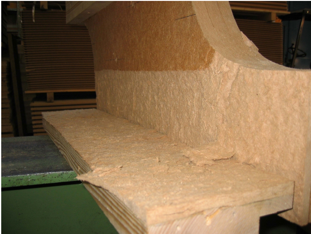
Bild 8-3 Schubversagen in Plattenebene in einem Versuchskörper mit aufgeklebten Seitenhölzern
