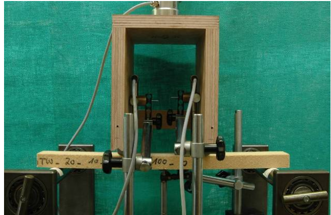
Bild 9-3 Versuchsdurchführung im Kurzzeitbiegeversuch (Maße in mm)
