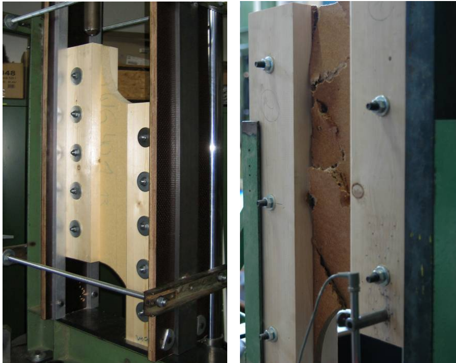
Bild 8-4 Eingebauter Versuchskörper und typisches Versagen
