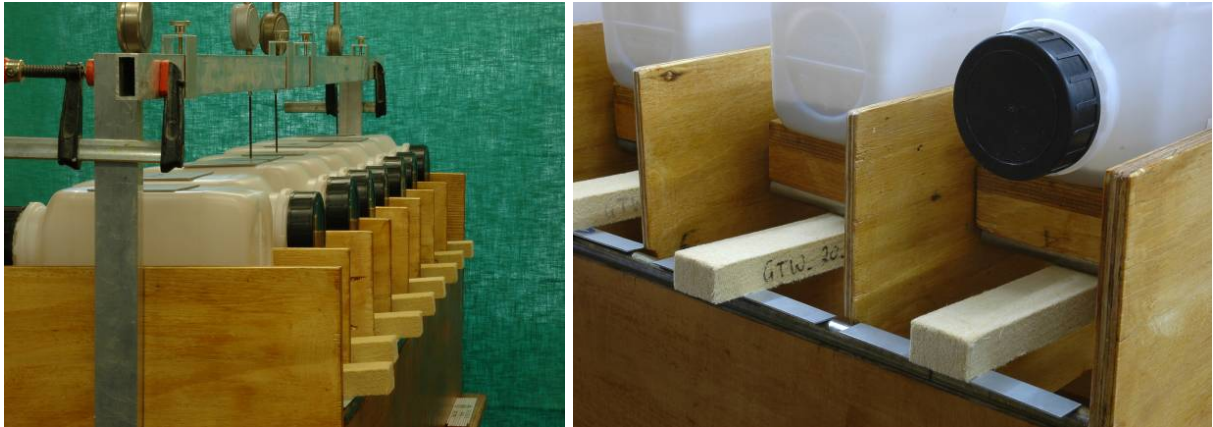
Bild 9-8 Versuchsaufbau und Lasteinleitung im Dauerstandversuch
