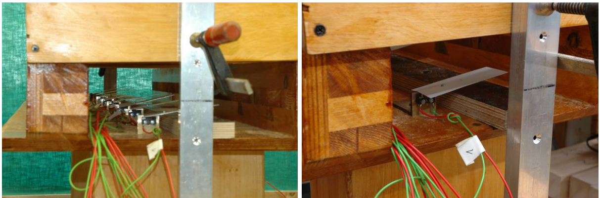
Bild 9-9 Messeinrichtung für die elektronische Zeitmessung bis zum Versagen der Versuchskörper
