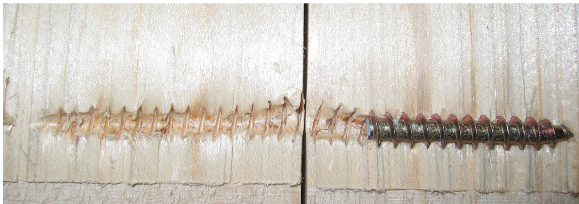
Bild 7-3 Geöffneter Druckscherkörper einer Holz-HFDP-Verbindung mit einer speziellen Schraube mit Halteteller
