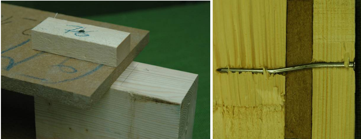
Bild 7-14 Typisches Versagen mit der Ausbildung von zwei Fließgelenken
