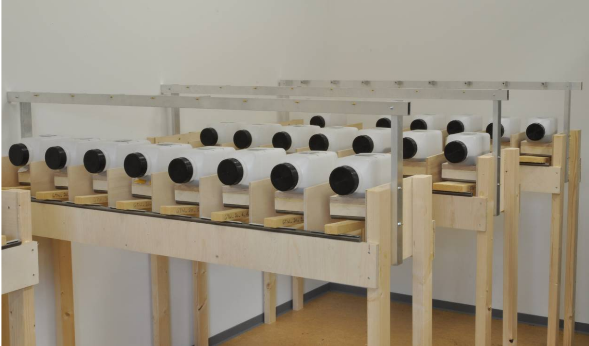
Bild 9-11 Versuchsaufbau der Versuchsreihen ohne elektronische Zeitmessung im Klima 20/65 mit Vorrichtung für die Verformungsmessung
