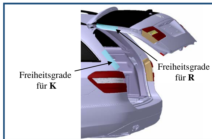
Abbildung 5.6: Freiheitsgrade der Koppelstellen für das Modulkonzept „Einseitiger Spindelantrieb“
