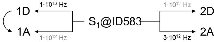
**Abbildung 6.5:** Ratenabschätzung des Ladungstransfers vom Donor zum Akzeptor: Für 1D und 2A ist  $\Delta E \sim -\lambda$ , so dass sich hier die höchsten Ladungstransferraten ergeben. Aus energetischen Gründen erfolgt anschließend ein Ladungstransfer von 1D nach 1A in der aufrechten Konformation.
