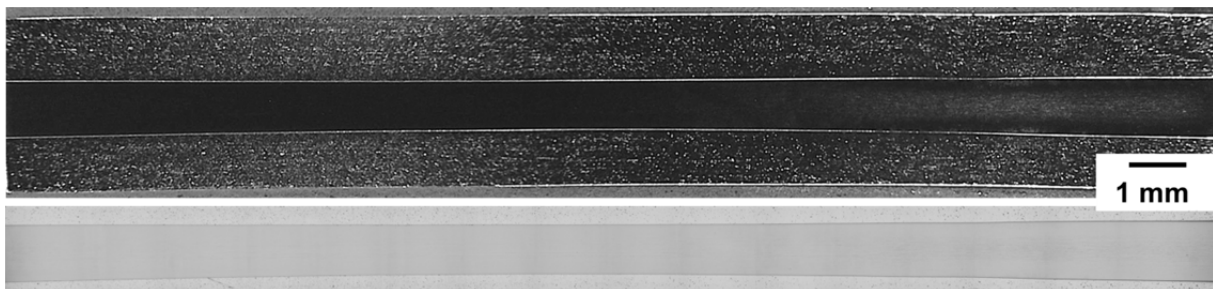
Abbildung 5.20: Längsschliff einer mit 11,1 Vol.-% verstärkten T4 (F)-Probe bei \epsilon_t = 4 % (oben: Gesamtübersicht, unten: Übersicht entlang Grenzfläche)
