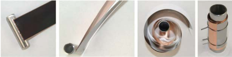
Bild A.9.: Machbarkeitsstudie zur Realisierung von Wolframrohren aus Wolframfolie mit Hilfe der elektromagnetischen Pulstechnik, EMPT. Wolframfolie und Kupferfolie (Dicke jeweils 0,1\text{ mm} ) sind um ein Rohr ( 12 \times 1 ) aus austenitischem Stahl (1.4571) gewickelt. Die Versuche werden am Institut für Transurane, ITU, von Herrn John McGinley betreut.
