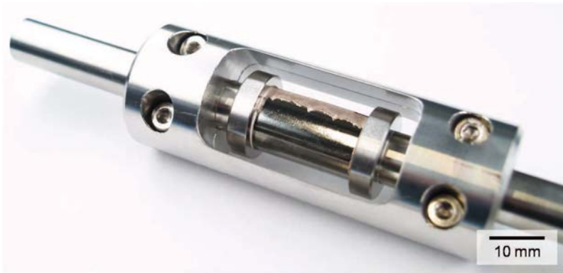
Bild 4.53.: Aufbau des Prüflings für den Berstversuch. Ein gewickeltes Laminatrohr, hergestellt durch Löten mit einem eutektischen Silber-Kupfer-Lot, ist an beiden Enden mit einem Edelstahlrohr verlötet. Eine Klammer um das Laminatrohr ermöglicht einen sicheren Ein- und Ausbau des Prüflings in den Innendruckversuchsstand.
