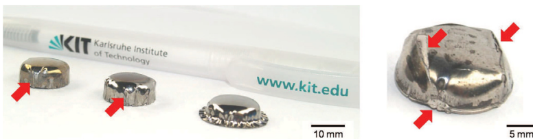
Bild 4.55.: Links: Das Tiefziehen von einzelnen Wolframfolienlagen, 100 \mu\text{m} , führt zur Bildung von Falten. Rechts: Auch beim Tiefziehen von Wolframlaminaten bilden sich Falten, zudem reißen die äußeren Wolframfolien ein.
