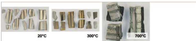
Bild A.25.: Bruchbilder von Laminatrohrproben nach einem Kerbschlagbiegeversuch. Material: Wolframlaminatrohr, hergestellt aus Wolframfolie, 100\ \mu\text{m} , verlötet mit Zirkonium, 100\ \mu\text{m} . Dimensionen: Länge 27\ \text{mm} , Durchmesser außen 15\ \text{mm} , Wandstärke 1\ \text{mm} .
