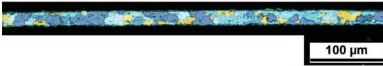
Bild 2.9.: Schnitt durch eine 20 \mu\text{m} Aluminiumfolie (kfz). Die Körner gehen über die Dicke der Folie. Quelle: J. Hirsch , Hydro Aluminium Deutschland GmbH - R&D.
