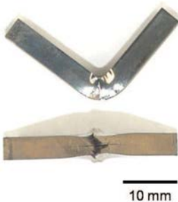
Bild 6.11.: Ein Wolfram-Kupfer-Laminat, getestet bei 300^{\circ}\text{C} , dissipierte 5,7\text{ J} . Durch die Orientierung in L-T Richtung kann die Energiedissipation nur durch plastische Verformung der Wolframfolie erfolgen.
