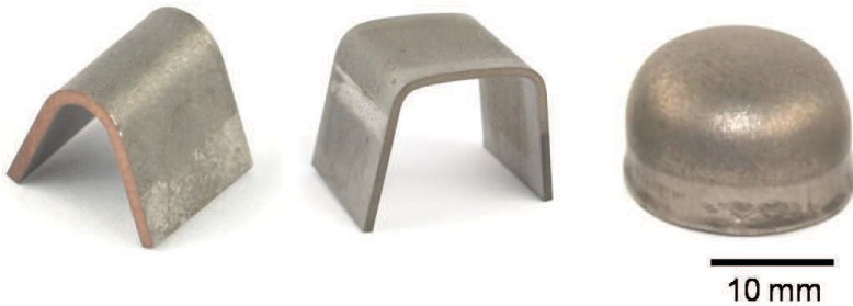
Bild 4.54.: Umformversuche an Wolframlattenmaterial, 1 mm. Verschiedene Winkel, Profile und Tiegel lassen sich Tiefziehen. Prozessparameter: 600°C, Geschwindigkeit: 0,1 mm/s, Vakuum.
