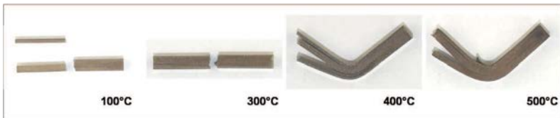
Bild A.13.: Kerbschlagbiegeproben ( 3\text{ mm} \times 3\text{ mm} \times 27\text{ mm} ) aus 15 Schichten Wolframfolie, 100\ \mu\text{m} , gegläht ( 1\text{ h} / 1800^\circ\text{C} ), verlötet mit 14 Schichten eines eutektischen Silber-Kupfer-Lots, 100\ \mu\text{m} . Orientierung in 0^\circ (L-S).
